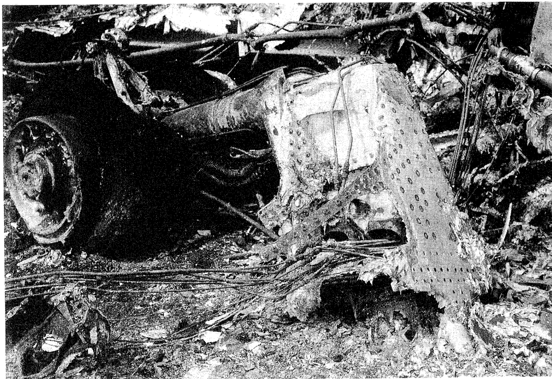
写真7 右主脚及びアタッチ・フィッティング
