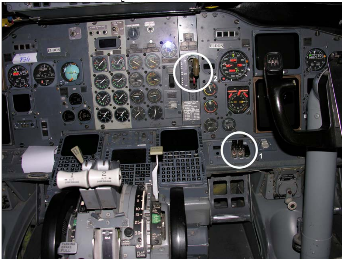
Рис. 2. Кабина экипажа самолета Boeing-737-300 EI-DON после посадки с невыпущенными стойками шасси 01.10.2008г. Тумблеры FLAP INHIBIT и GEAR INHIBIT – деактивированы, TERRAIN INHIBIT – активирован (1), рычаг уборки/выпуска шасси в положении OFF – шасси убрано (2).
