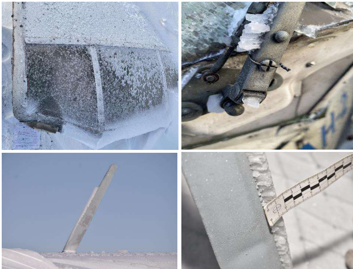
Рис. 16. Внешний вид ВС Ан-2 RA-71165 с признаками обледенения конструкции самолета
