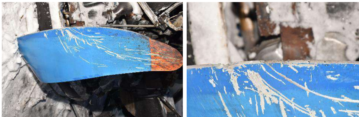
Рис. 17. Повреждения ВВ самолета Ан-2 RA-71165
