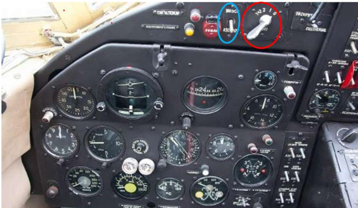
Рис. 19. Расположение в кабине самолета Ан-2 переключателя «Запуск» и переключателя магнето ПМ-1 перед запуском двигателя
