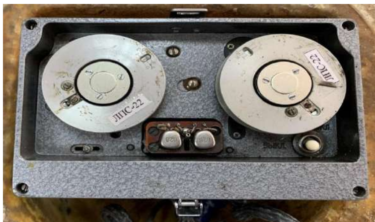
Рис. 11. Состояние звуконосителя речевого регистратора МС-61 после вскрытия контейнера
