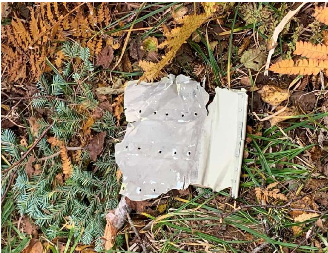
Рис. 16. Фрагмент обшивки ВС на месте второго касания
