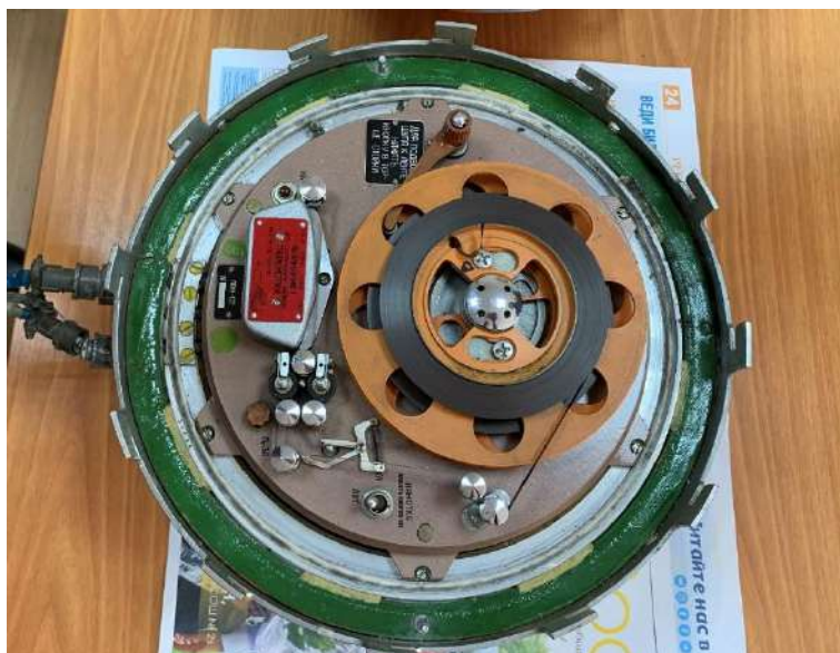
Рис. 10. Состояние магнитной ленты МСП-12-96 после вскрытия контейнера
