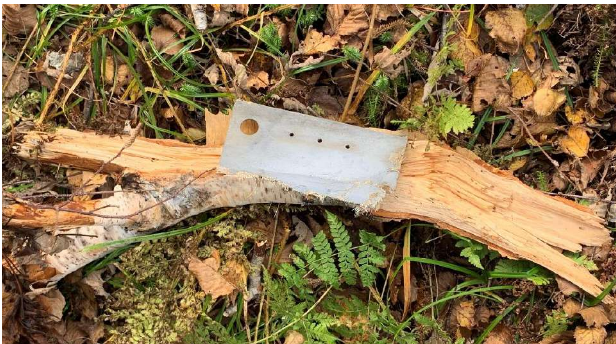
Рис. 14. Часть дерева с фрагментом обшивки (показано красной стрелкой)
