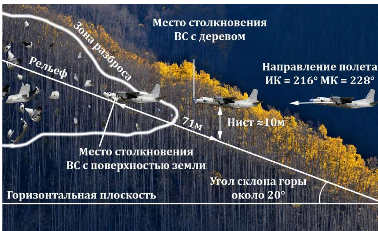
Рис. 27. Схема движения ВСЛ на заключительном этапе полёта
