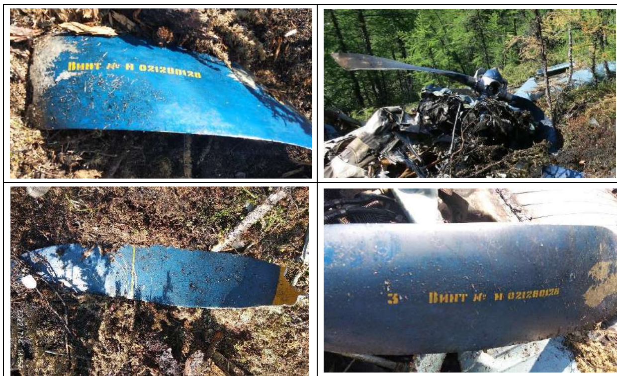
Рис. 7. Общий вид ВВ и лопастей с повреждениями
