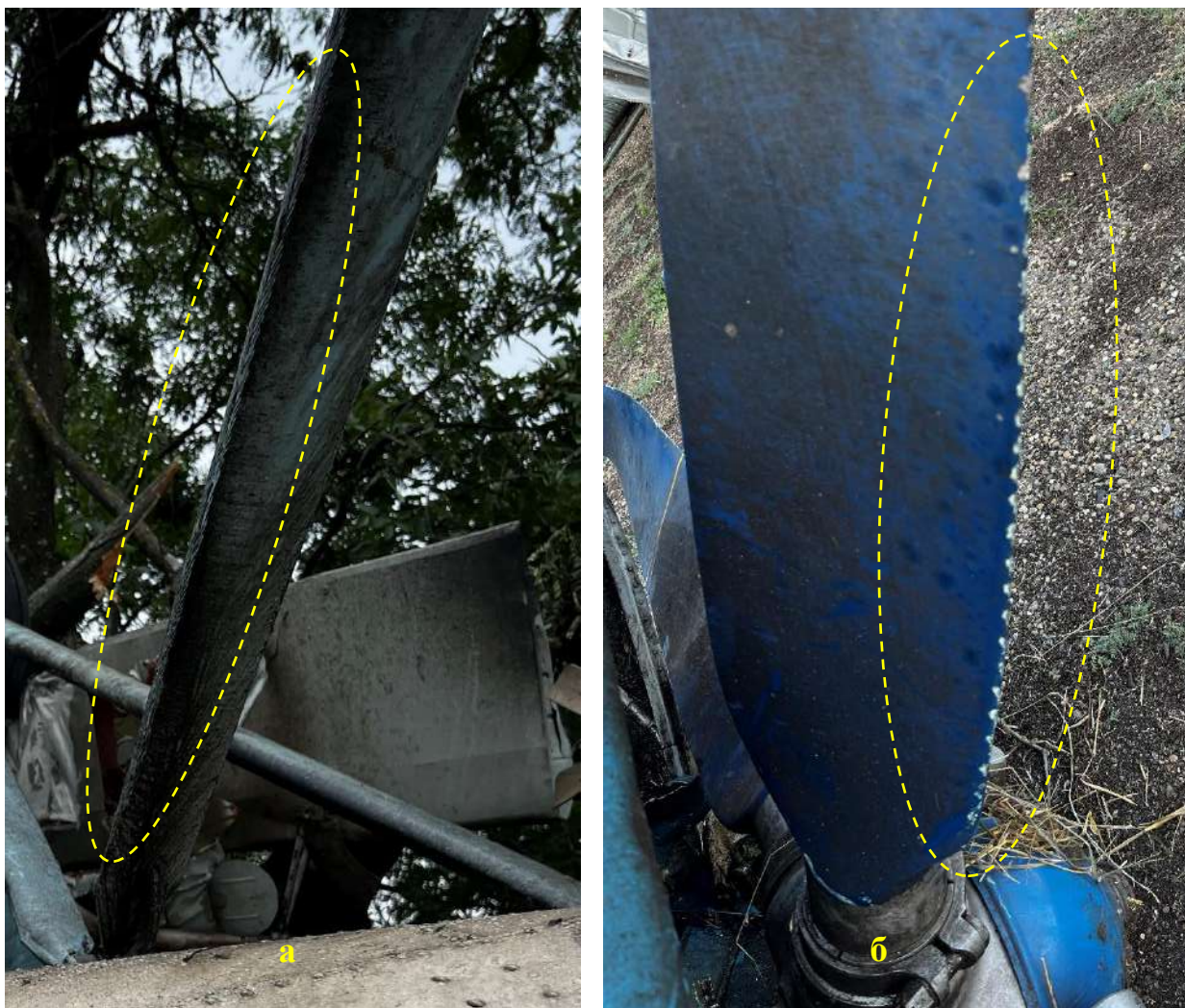
Рис. 11. Следы от столкновения с проводами ЛЭП а) на переднем подкосе шасси, б) на лопасти ВВ
