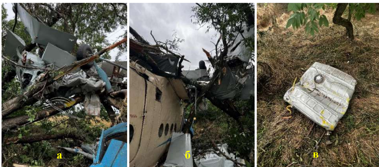
Рис. 2. Поврежденные элементы конструкции (а, б – левая полукоробка крыльев, в – топливный бак)
