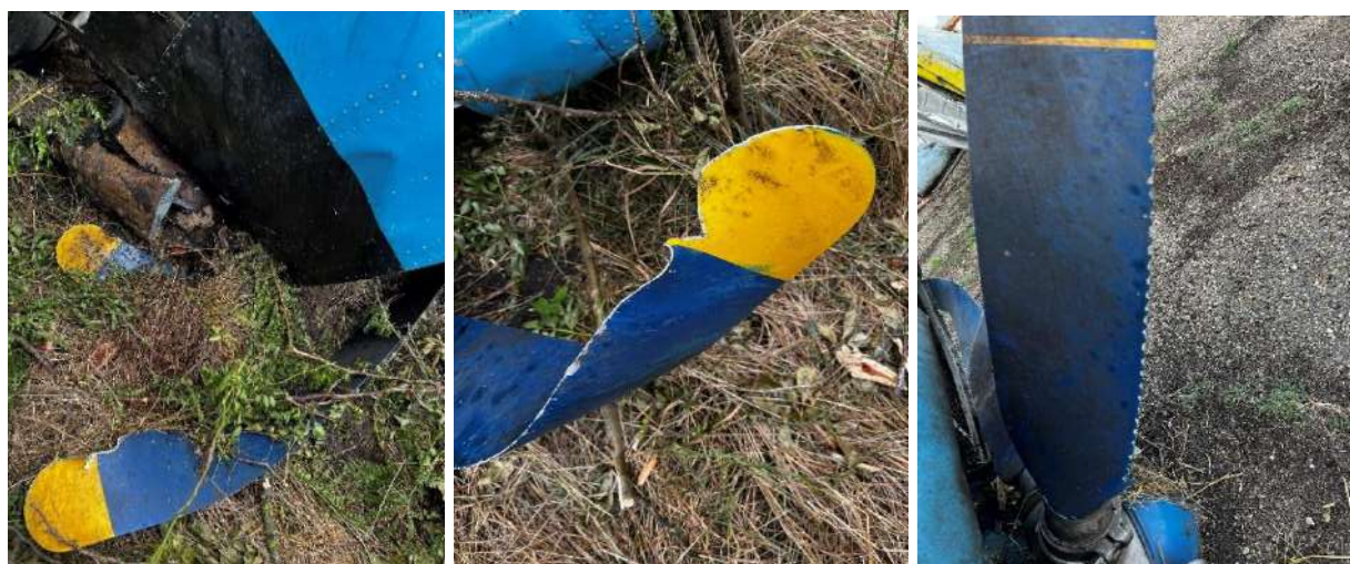
Рис. 5. Повреждения лопастей ВВ
