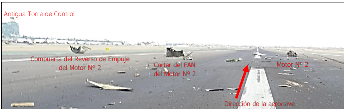
Distribución de Restos del Motor Nº 2 (Derecho) en el lugar del Accidente
