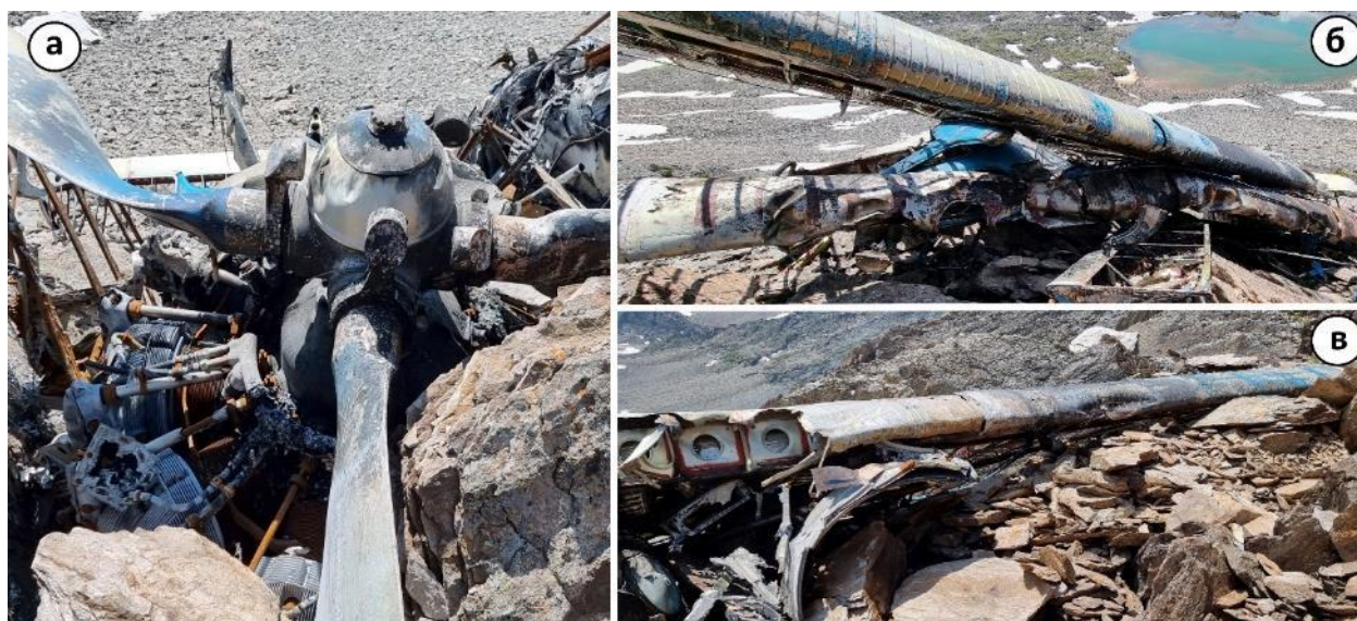
Рис. 14. Повреждения ВС: а) обтекатель ВВ, картер и двигатель; б) правые верхнее и нижнее полукрылья; в) левое полукрыло
