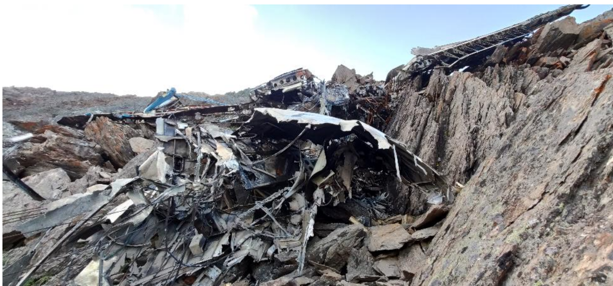
Рис. 4. Фюзеляж, уничтоженный пожаром
