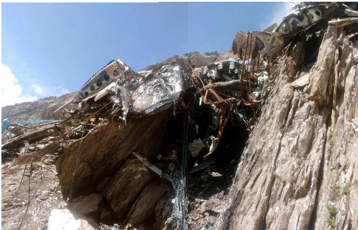
Рис. 5. Кабина экипажа, уничтоженная пожаром
