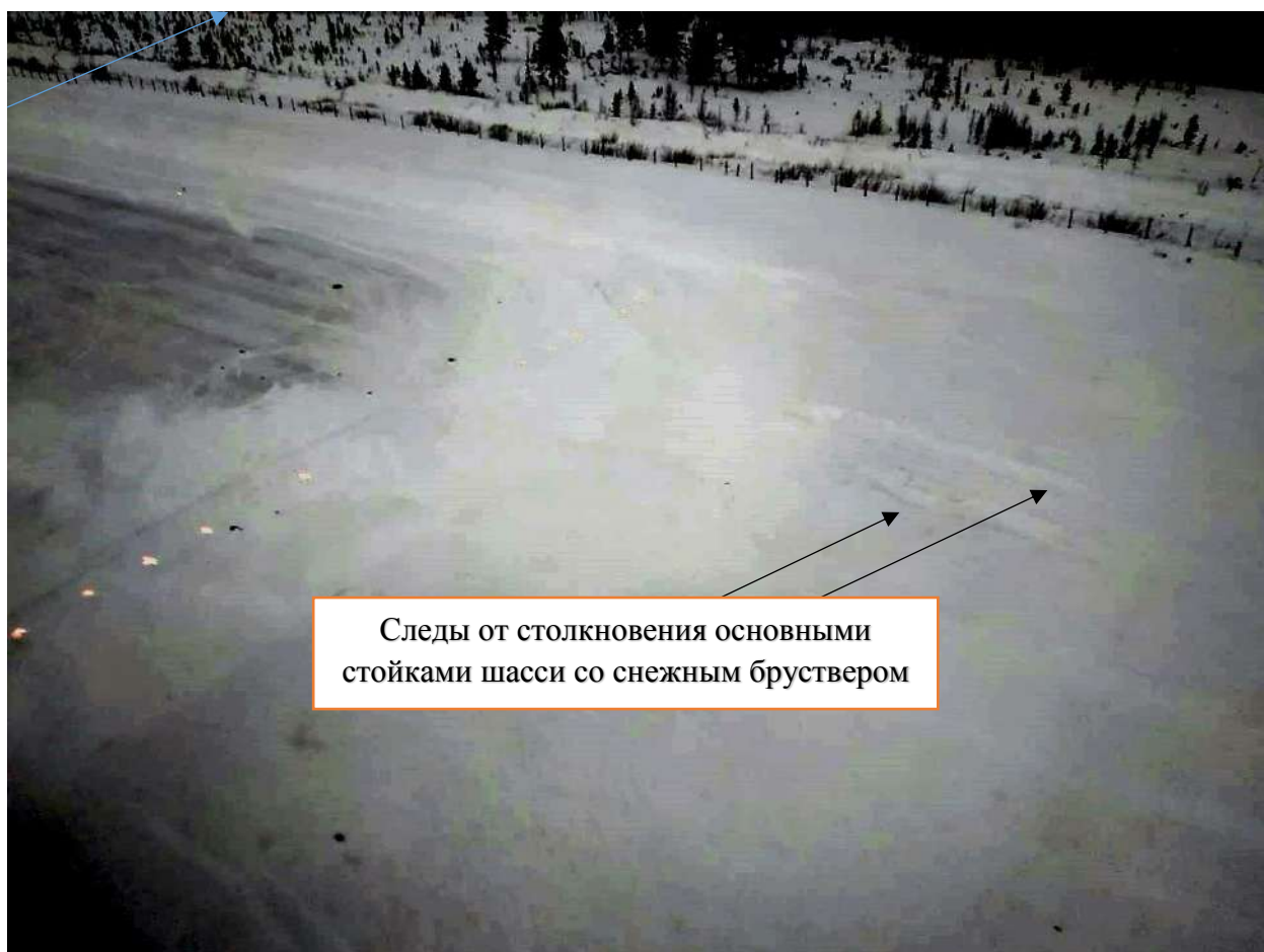
Рис.21. Следы от столкновения основными стойками шасси ВС со снежным бруствером (фото выполнено с вертолета 09.02.2020)
