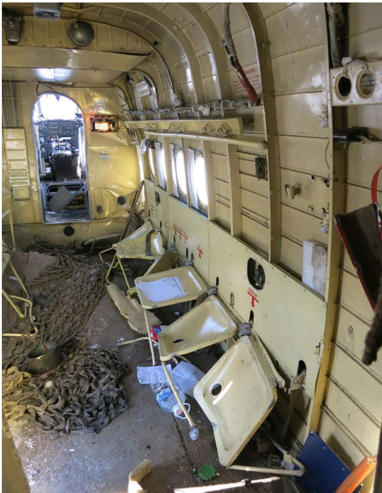
Рис. 11. Повреждения грузопассажирской кабины (правый борт)
