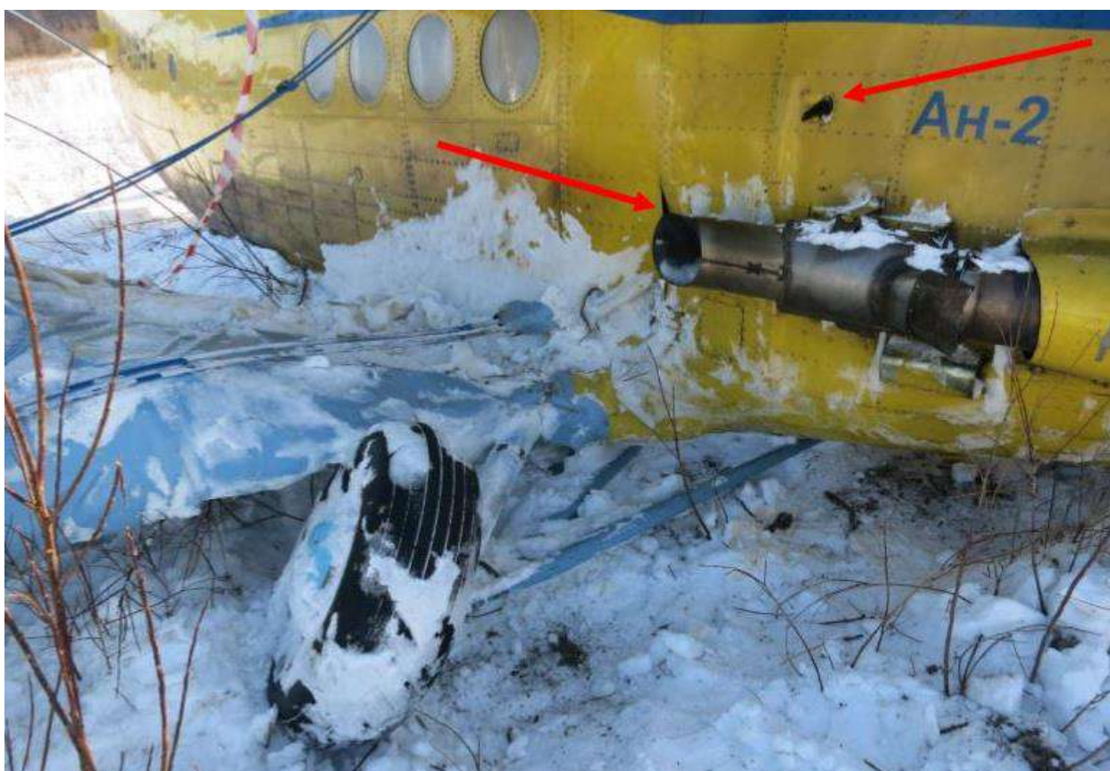
Рис. 8. Деформации и порывы правого борта (показаны стрелками)
