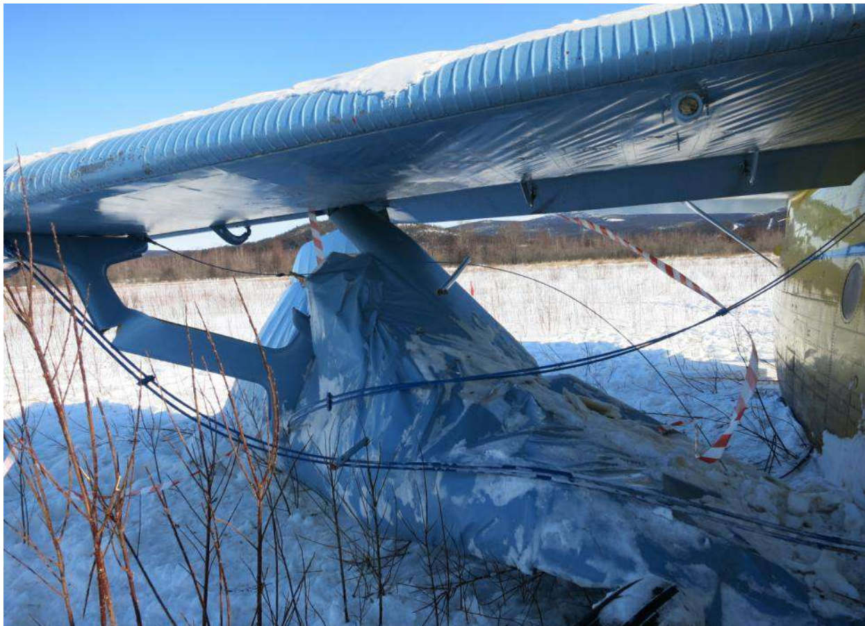
Рис. 13. Деформации и разрушения правой коробки крыльев
