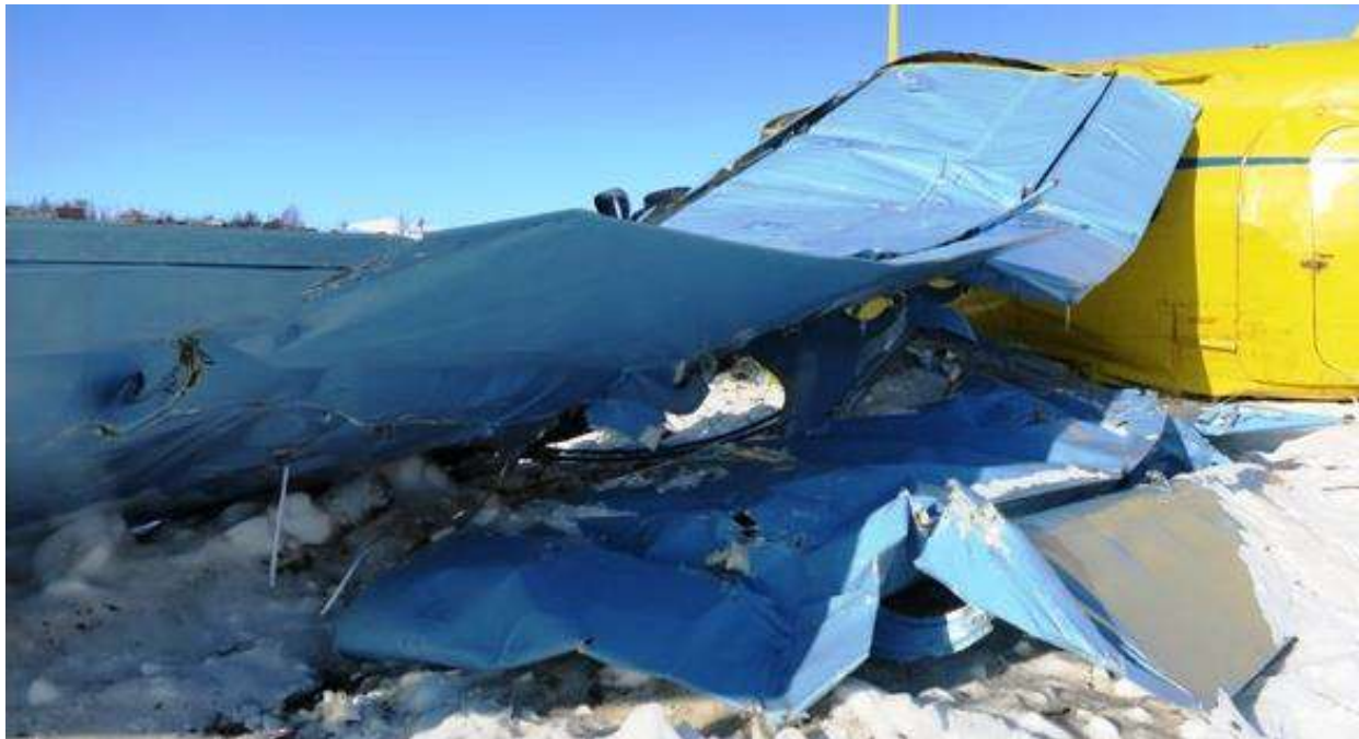
Рис. 12. Деформации и разрушения левой коробки крыльев
