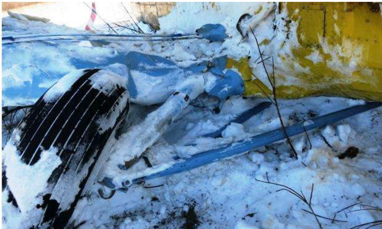
Рис. 14. Деформации и разрушения правой стойки шасси
