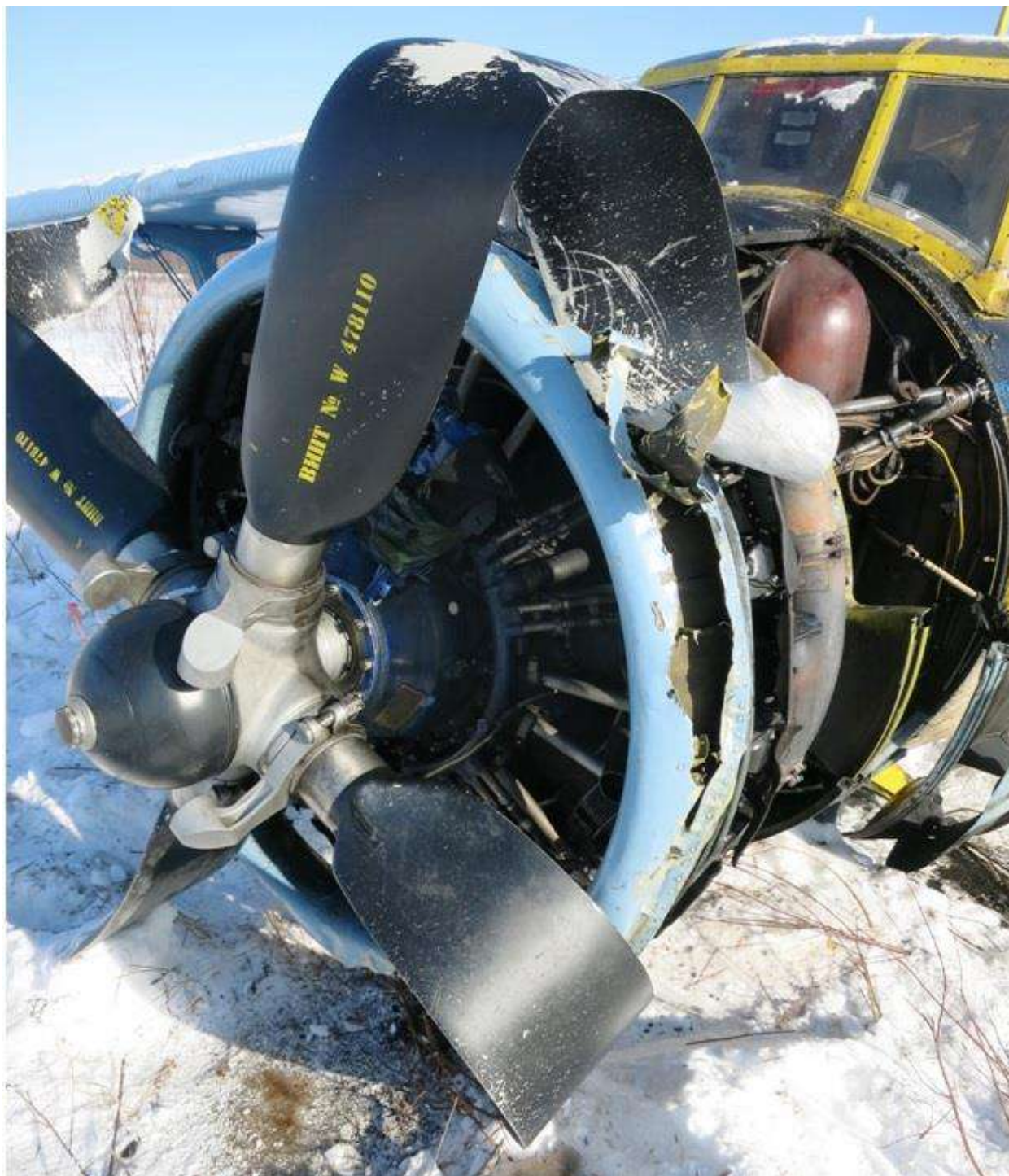
Рис. 16. Деформации и повреждения двигателя и лопастей ВВ (вид спереди слева)
