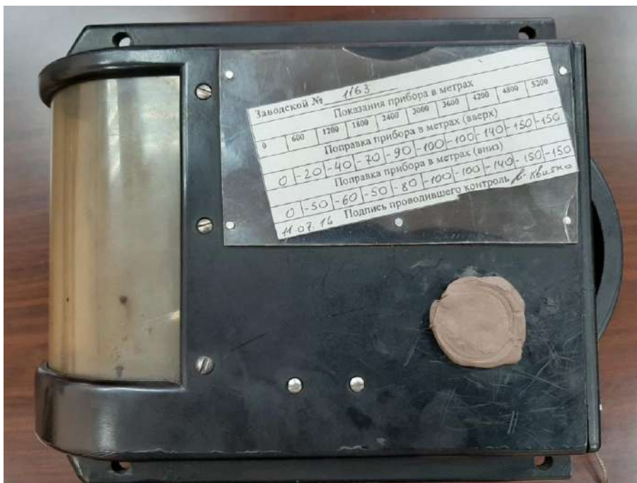
Рис. 2. Барограф-высотописец АД-2, изъятый с ВС Ан-2 RA-40642 на месте АП
