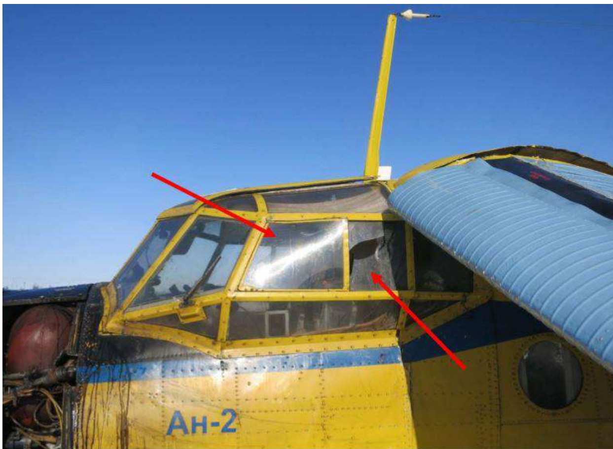
Рис. 9. Деформации и разрушение остекления фонаря кабины пилотов (показаны стрелками)
