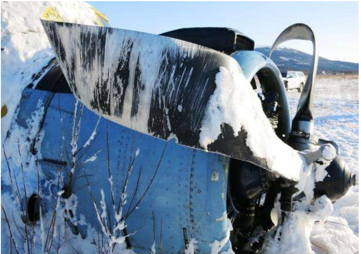
Рис. 17. Деформации и повреждения двигателя и лопастей ВВ (вид спереди справа)
