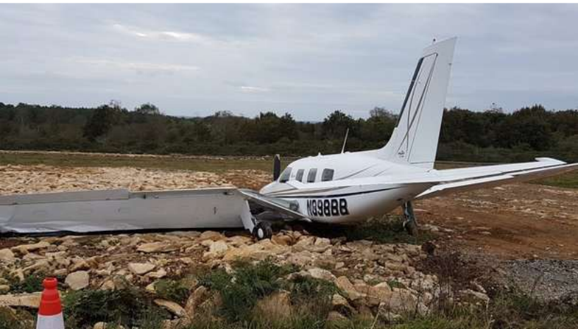
LE PA46 N898BB IMMOBILISÉ DANS LE REMBLAI APRÈS LA RESA (SOURCE BEA)
