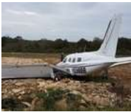
LE PA46 N898BB IMMOBILISÉ DANS LE REMBLAI APRÈS LA RESA (SOURCE BEA)
