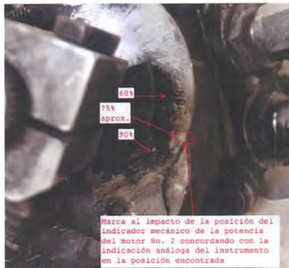
1.18.6 indicador mecánico de potencia del motor derecho
