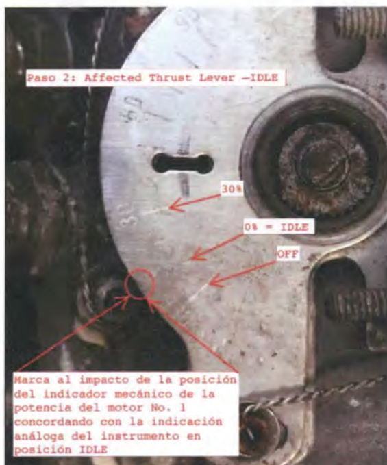
1.18.4 indicador mecánico de potencia del motor izquierdo
