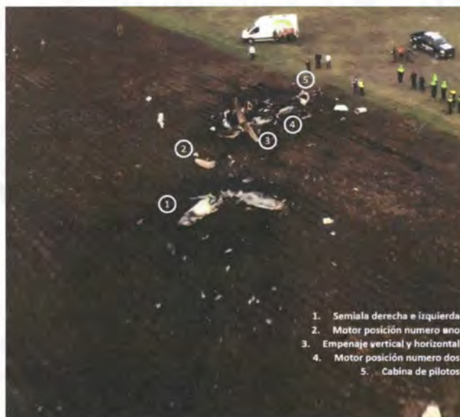
Fig. 1.14.3., dinámica de la destrucción de la aeronave la cual realiza el impacto en un solo punto
