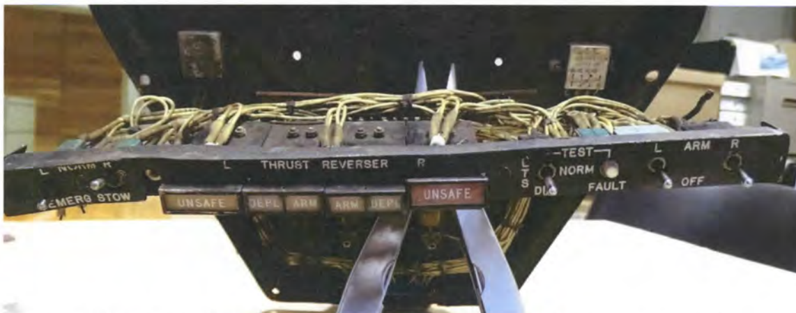
1.18.3., panel anunciador de motor localizado entre los restos el cual fue resguardado por el investigador a cargo
