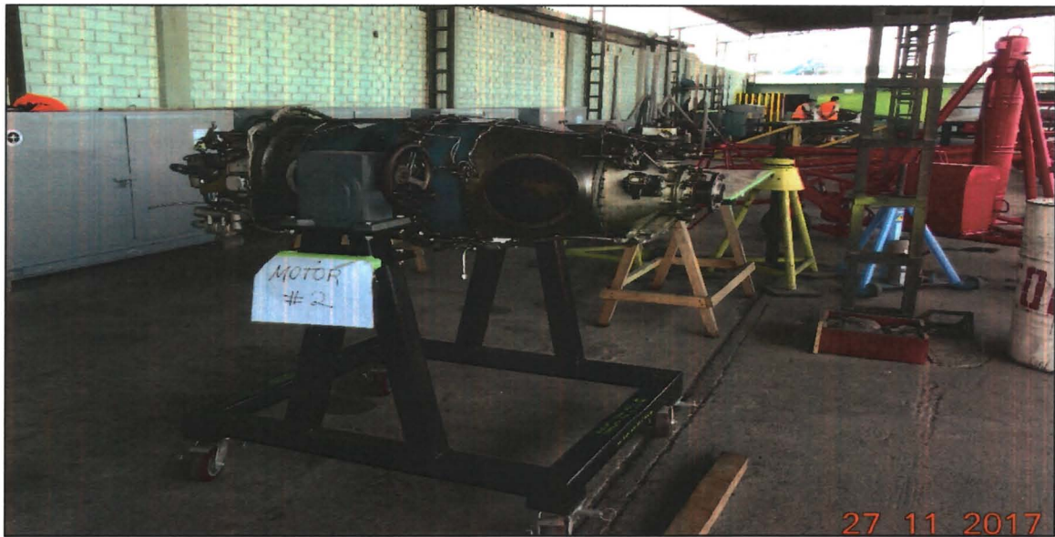
Motor Derecho Modelo PT6A-42, S/N N°94306
