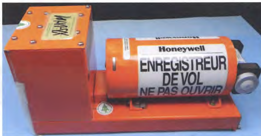
Fig. 1.10.2. Condiciones exteriores del SSCVR
