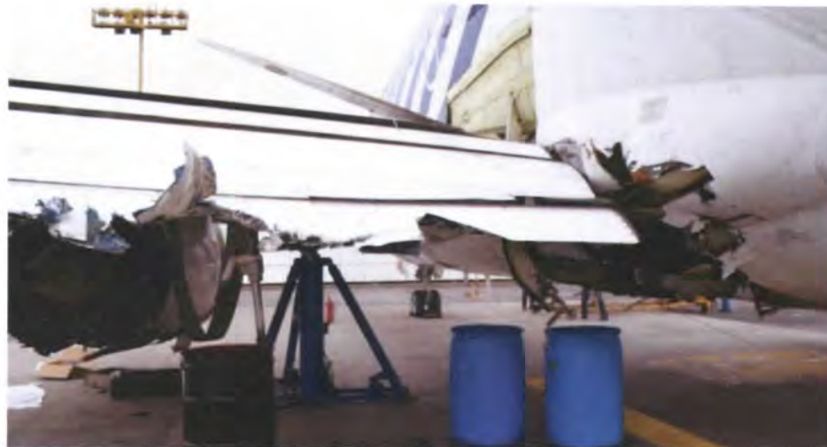
Fig. 1.3.2 Desprendimiento de la pierna izquierda, y daños en la parte inferior del motor posición número uno
