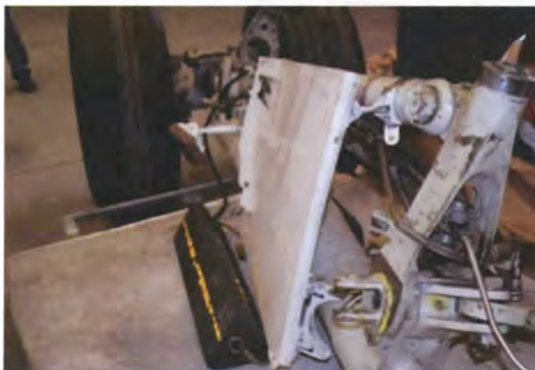
Fig. 1.3.3. Pierna izquierda del tren de aterrizaje
