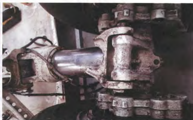
Fig. 1.3.4. Fractura del lower torque link
