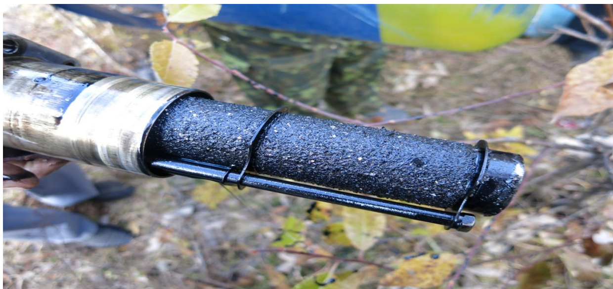
Рис. 9. Состояние фильтра-сигнализатора стружки в маслосистеме
