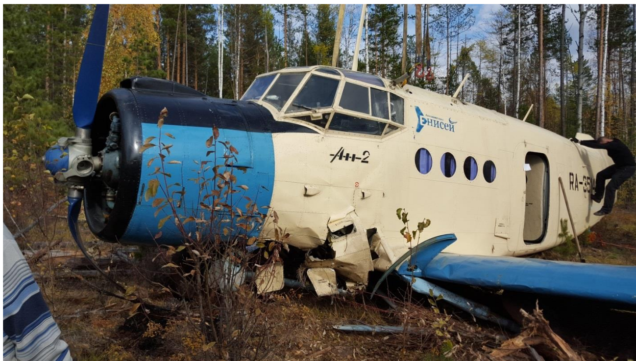
Рис. 3. Состояние левого борта и нижней части фюзеляжа
