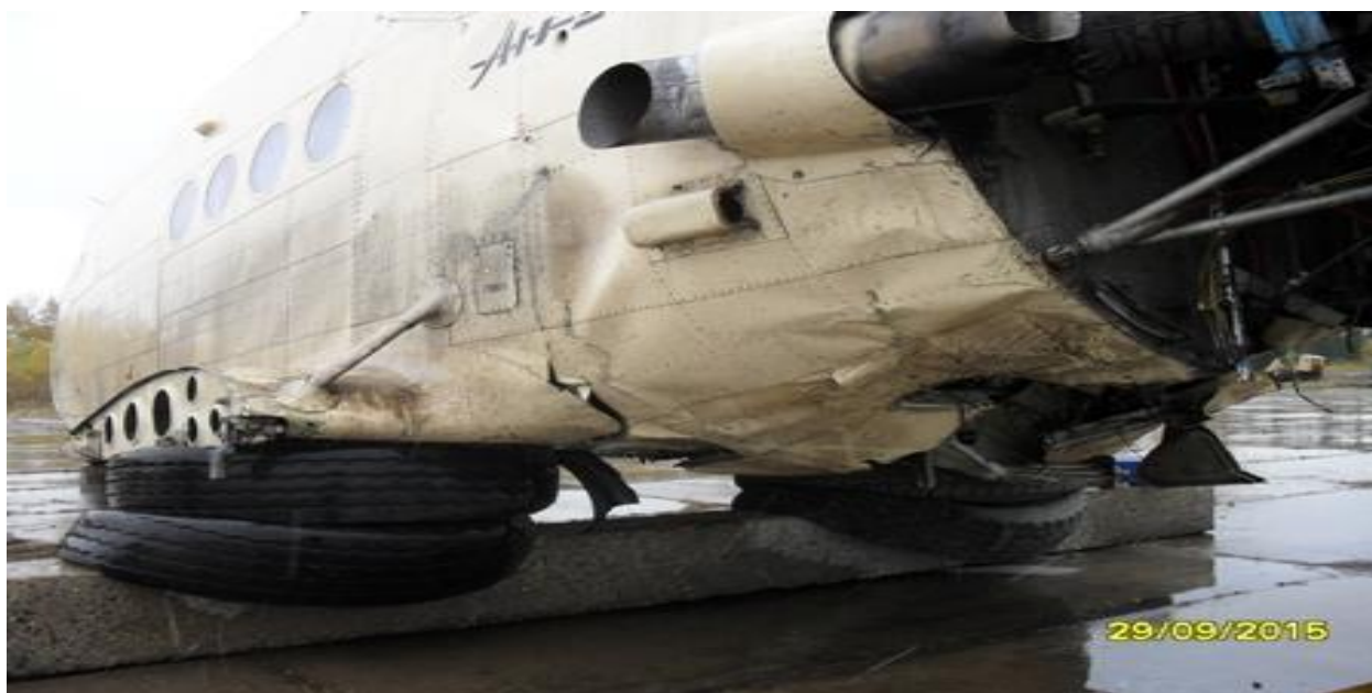
Рис. 2. Состояние правого борта и нижней части фюзеляжа
