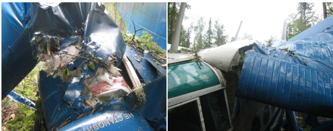
Рис. 5. Места повреждения обшивки
