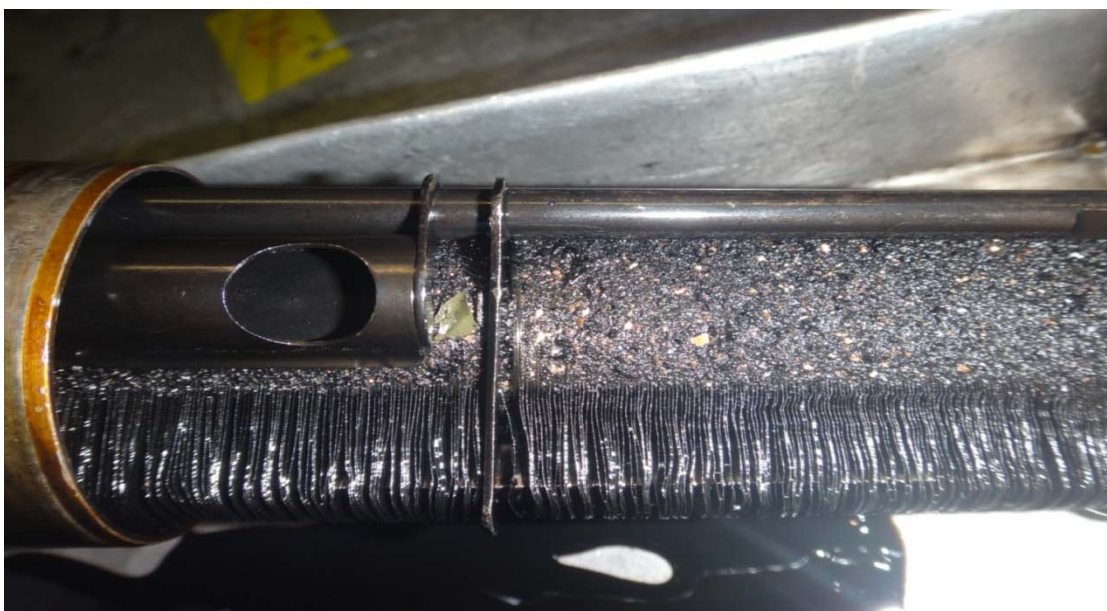
Рис. 24. Состояние фильтра МФМ-25 с отложениями скоксовавшегося масла
