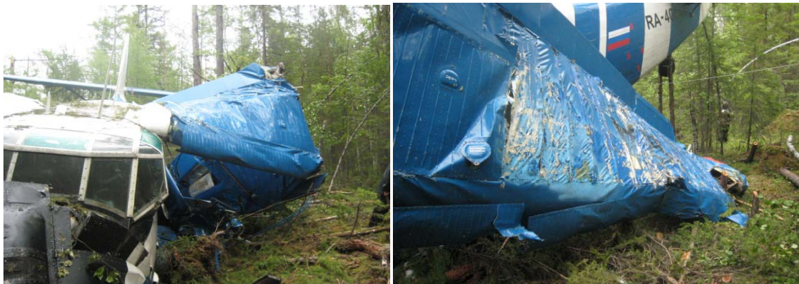
Рис. 7. Повреждения элементов крыла
