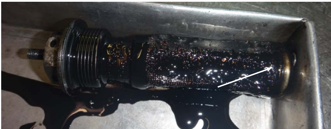
Рис. 28. Вид повреждения сетки фильтра-сигнализатора стружки (стрелкой показано место отсоединения сетки от корпуса).
