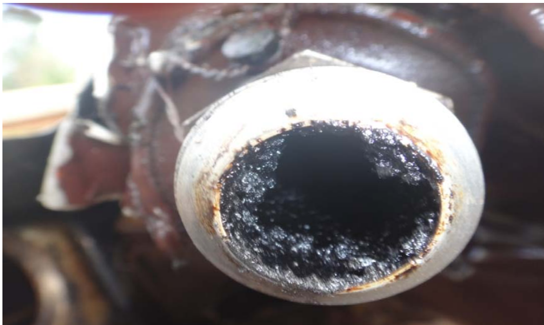
Рис. 22. Вид канала штуцера маслобака, заполненного отложениями скоксовавшегося масла (примерно на 1/3 части проходного сечения)
