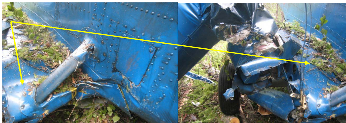
Рис. 4. Места повреждения шпангоутов и нервюр центроплана (стрелкой указаны фермы центроплана)
