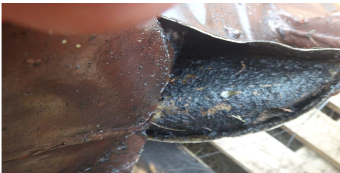
Рис. 21. Вид разрушенного маслобака с вынесенным фрагментом загрязненной внутренней поверхности стенки
