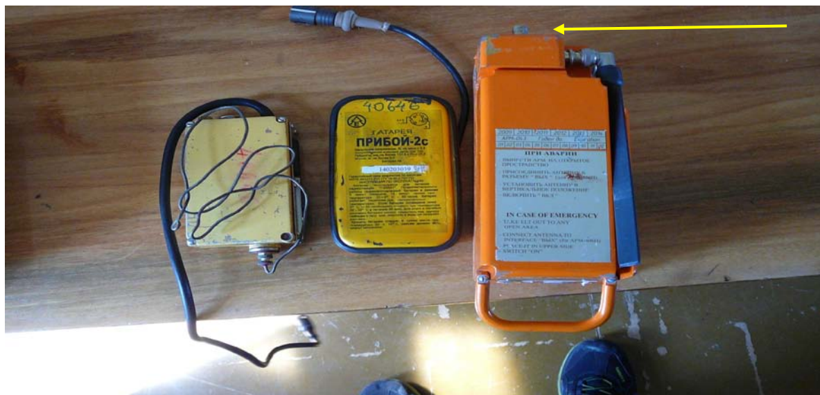
Рис. 20. Положение антенны при попытке его включения экипажем ВС (стрелкой указано необходимое положение антенны при работе в ручном режиме)
