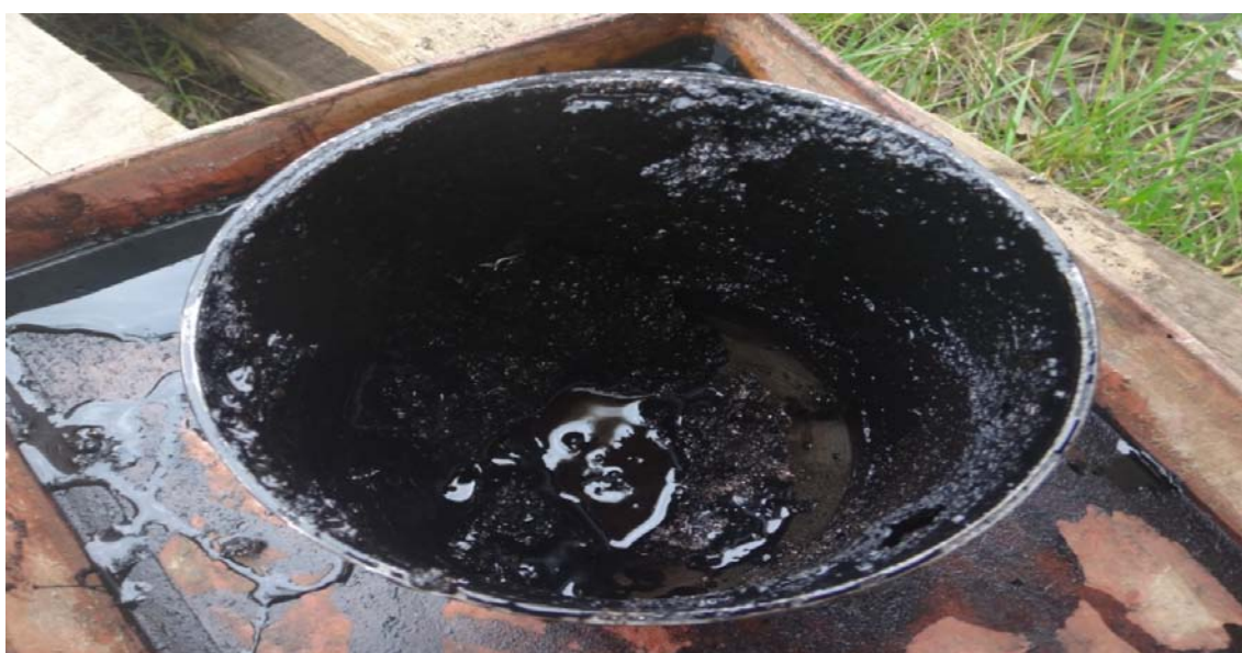
Рис. 27. Вид стенки корпуса центрифуги с обильными отложениями скоксовавшегося масла
