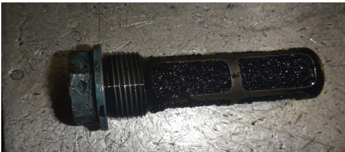
Рис. 26. Состояние фильтра регулятора оборотов Р-9СМ2 о отложениями скоксовавшегося масла
