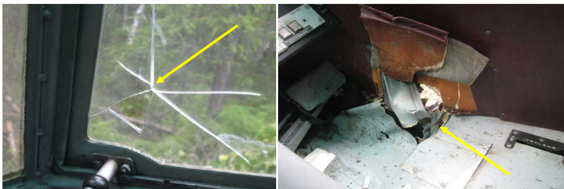
Рис. 6. Трещины стекла и пробоина пола на правой стороне фюзеляжа в кабине самолета (указано стрелками)
