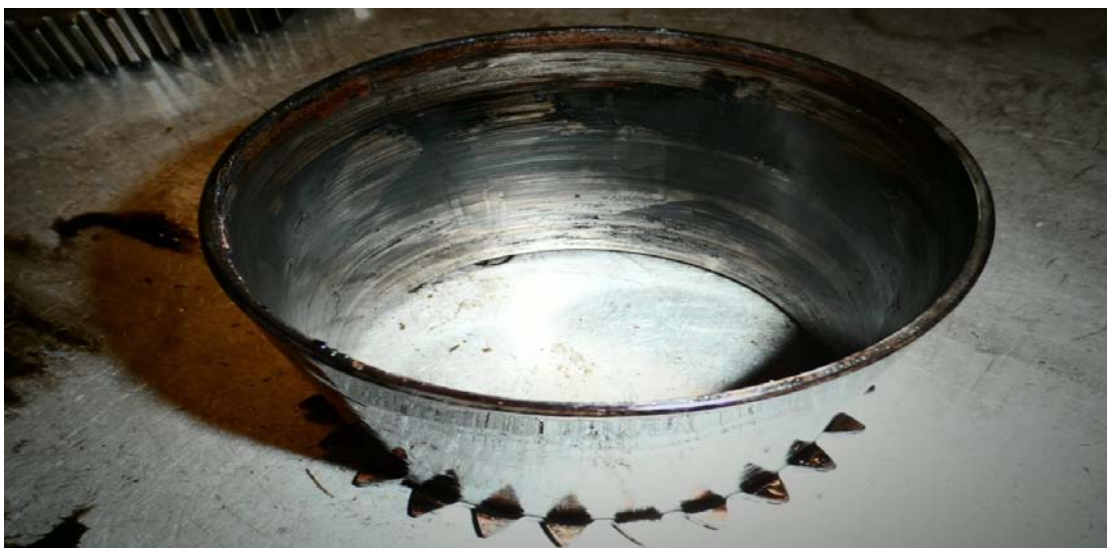
Рис. 23. Вид поврежденной рабочей поверхности втулки кривошипной головки главного шатуна
