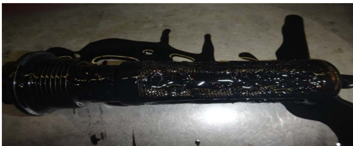
Рис. 25. Состояние фильтра-сигнализатора стружки с отложениями скоксовавшегося масла
