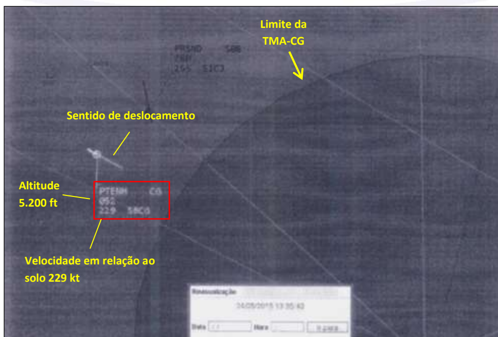
Figura 15 - Imagem RADAR do momento em que a aeronave inicia a descida, registrada às 13h35min40s (UTC).
