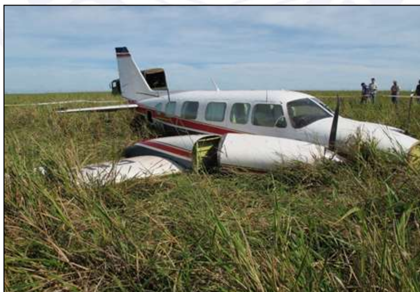
Figura 8 - Condição da aeronave após o impacto contra o solo.
