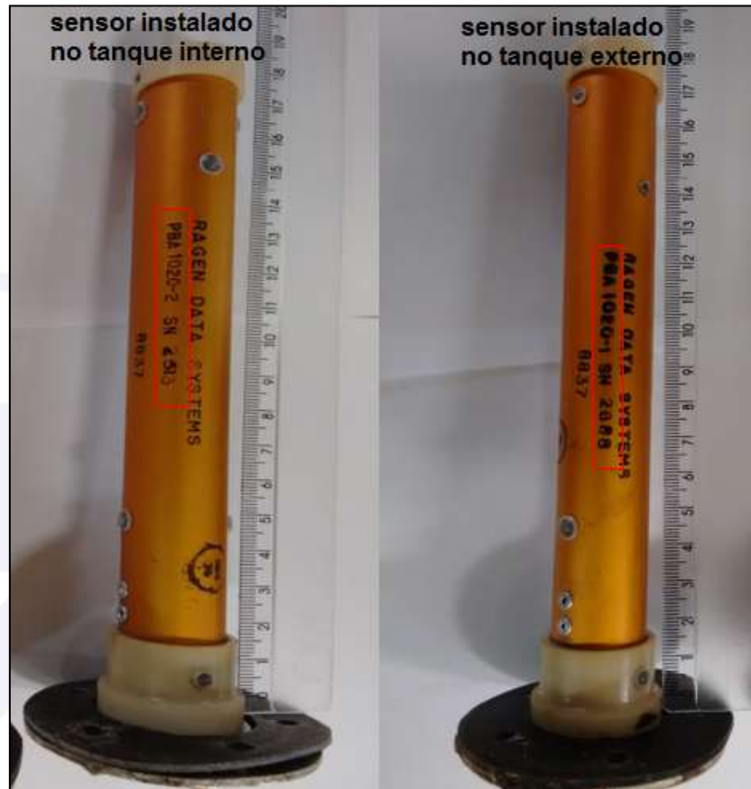
Figura 11 - Sensores de nível de combustível dos tanques da asa esquerda.
