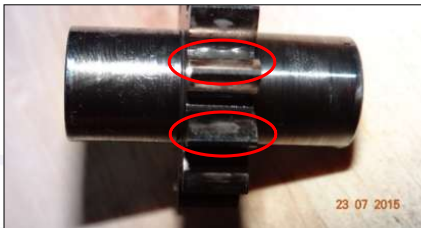
Figura 14 - Detalhe das marcas na engrenagem da bomba de combustível do motor esquerdo.
