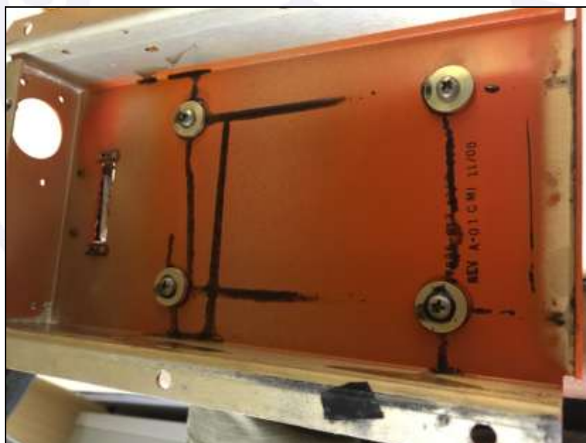
Figura 6 - Marcas de fluido no interior do CVR.
