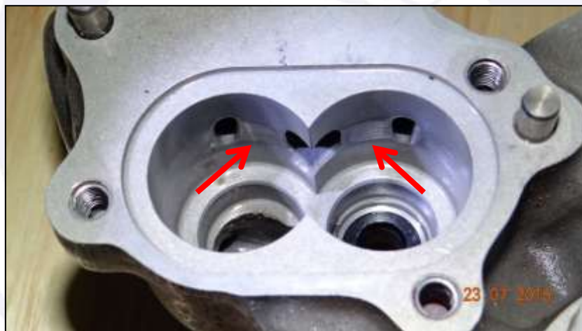
Figura 13 - Detalhe das marcas de fricção no corpo da bomba de combustível do motor esquerdo.
