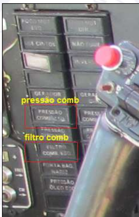
Figura 3 - Painel múltiplo de alarmes
