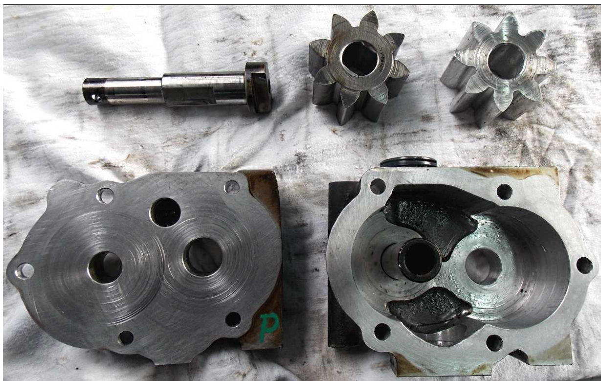
59 - Pompa olejowa prawego silnika – widoczne zarysowania powierzchni wewnętrznych.
