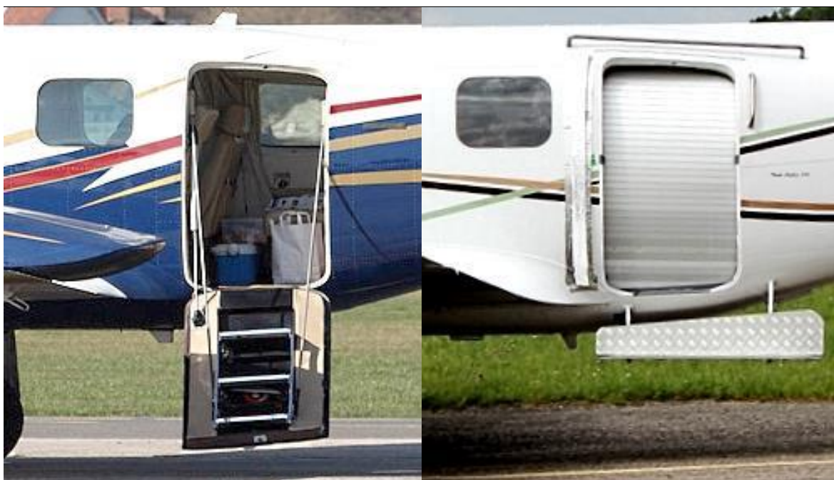
3, 4 - Zasadnicza przeróbka strukturalna samolotu PA-31P N11WB. Z lewej stan przed przeróbką (na zdjęciu inny samolot - widoczne drzwi ciśnieniowe), z prawej samolot N11WB po przeróbce (widoczne drzwi roletowe, deflektor, poręcz, uchwyt i stopień). [fot. Bartosz Budzisz, Skrzydła.org + powszechnie dostępna domena internetowa].
