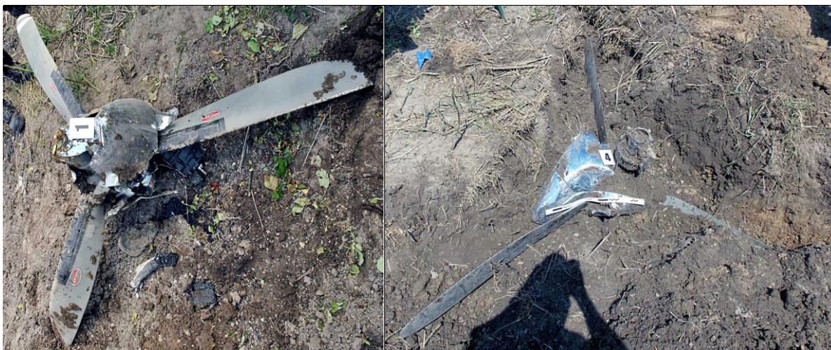
29, 30 - Widok śmigła lewego i wbitego w ziemię śmigła prawego odnalezionych na miejscu zdarzenia, widoczny również w obu przypadkach wał śmigła wyrwany z przekładni.
