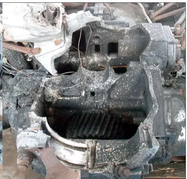
37 - Przód korpusu silnika prawego – widoczny przełom materiału korpusu po odłamaniu fragmentu reduktora oraz ślady intensywnego oddziaływania ognia.
