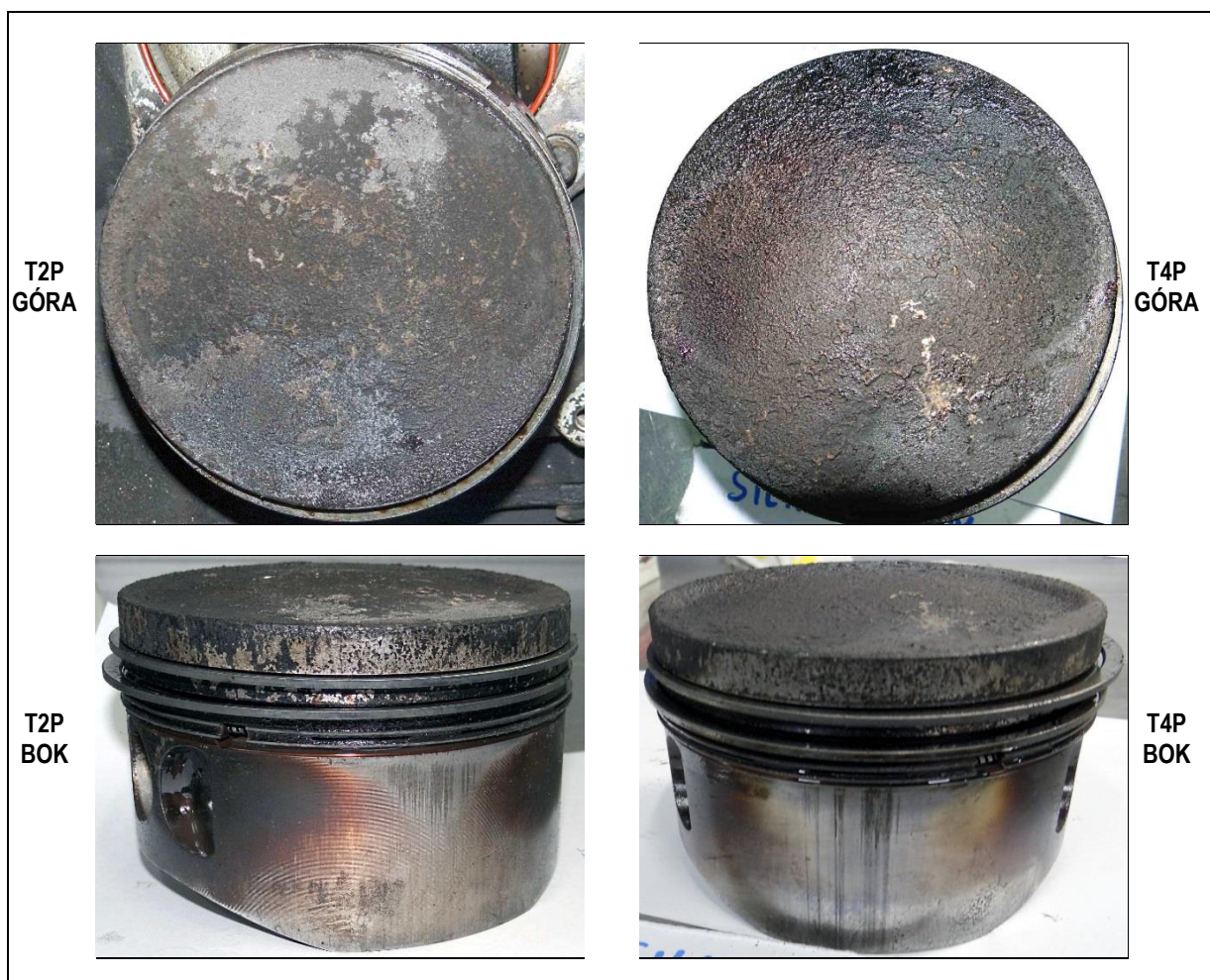
62 - Stan górnych i bocznych powierzchni niektórych tłoków w prawym silniku.
