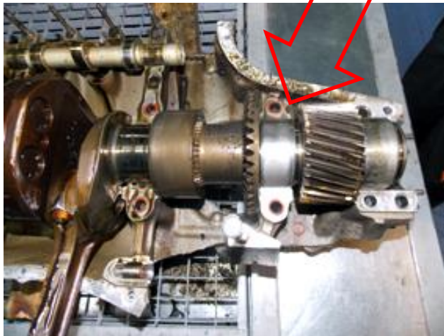
Widok wału korbowego i elementów przekładni zębatej połączonych z wałem korbowym silnika lewego
