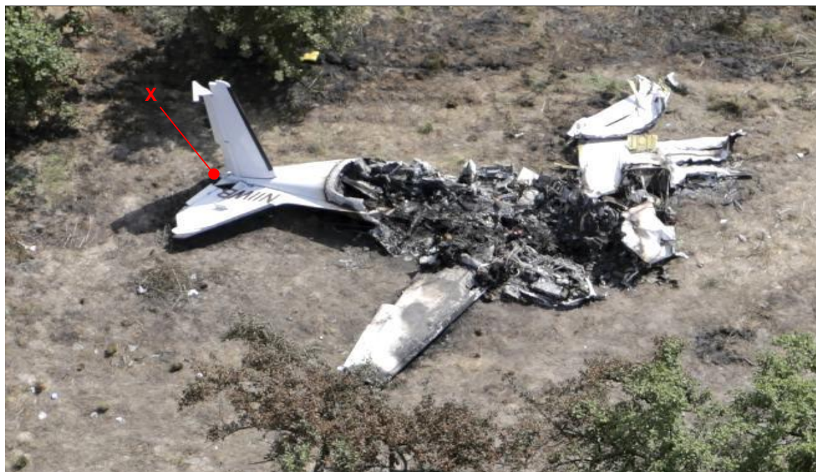
12- Samolot Piper PA-31P N11WB na miejscu wypadku sfotografowany w dniu 6 lipca 2014 r. w godzinach porannych. Kadłub z wypaloną kabiną odłamany od skrzydeł leży na prawym boku. Prawa kłapa niewidoczna, podwinięta pod prawe skrzydło [fot. TVN24/internet].
