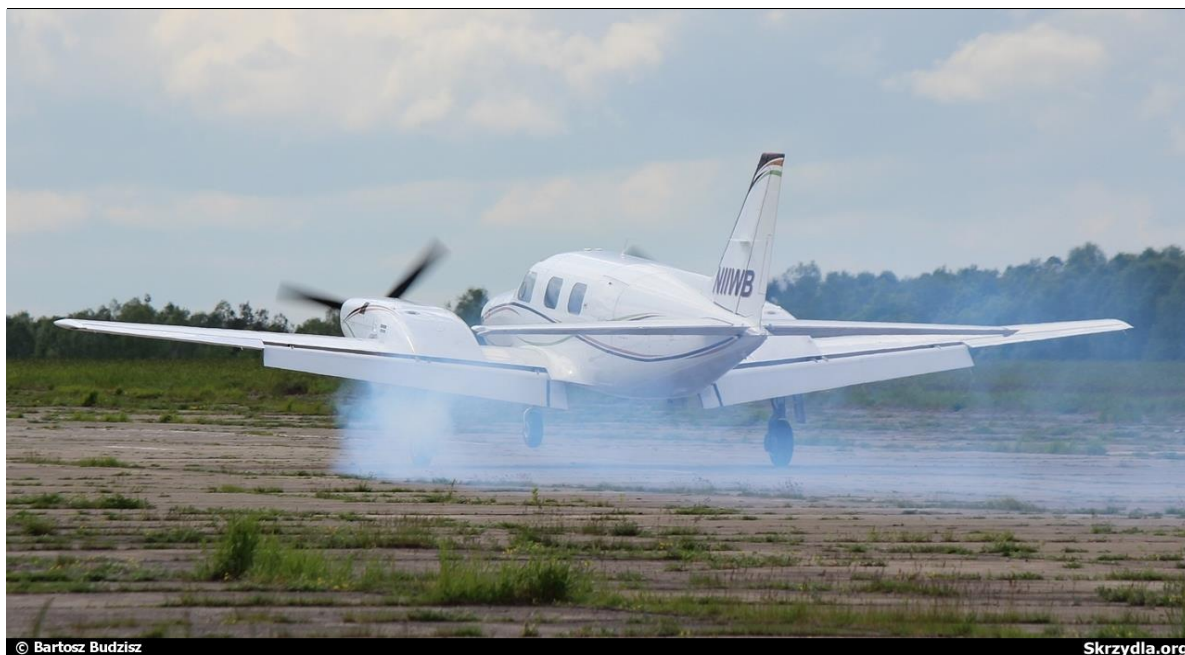
5 – Samolot Piper PA-31P N11WB sfotografowany 13 maja 2014 r. podczas lądowania na lądowisku Rudniki. Zwraca uwagę silne dymienie z lewego silnika, świadczące o jego defekcie. Drzwi kabiny jeszcze w stanie oryginalnym (kabina ciśnieniowa) – tj. przed przeróbką samolotu na wariant do wywożenia skoczków spadochronowych, dokonaną w drugiej połowie maja 2014 r. [fot. Bartosz Budzisz, Skrzydła.org].
