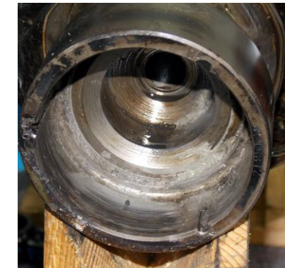
27, 28 - Końcówka wału korbowego z widocznymi głębokimi zatarciami, pozostałościami kołków wprasowanych w materiał wału korbowego i śladami oddziaływania wysokiej temperatury
