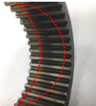
26 - Widok wewnętrznej części tulei, wielowypustu z widocznym śladem oddziaływania wysokiej temperatury
