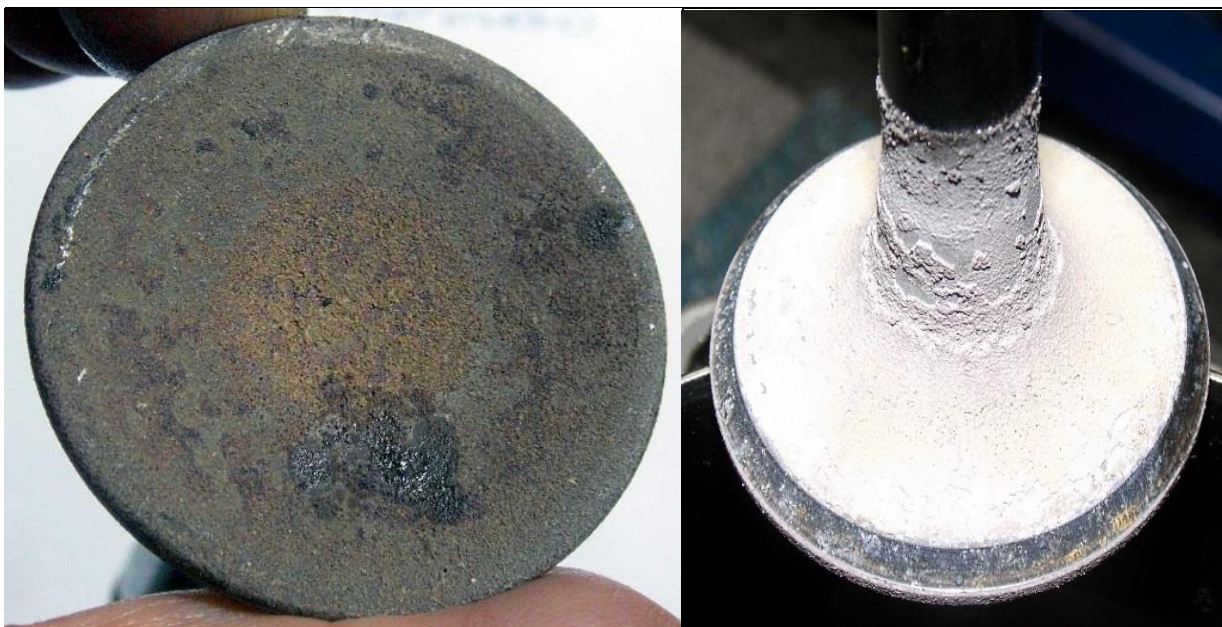
45, 46- Zawór wlotowy zdemontowany z cylindra nr 1 lewego silnika. Wyraźnie widoczny stan powierzchni czołowej i znaczny osad od strony trzonka.
