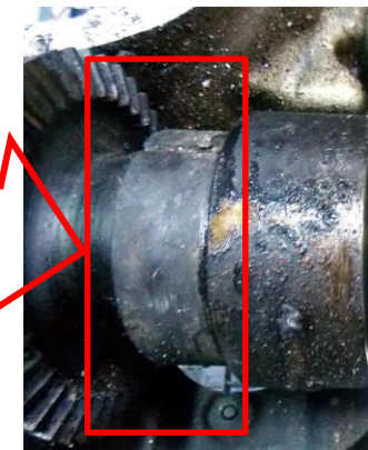
Widok wału korbowego i elementów przekładni zębatej połączonych z wałem korbowym silnika prawego oraz wysuniętej tulei łączącej wałek przekładni z wałem korbowym
