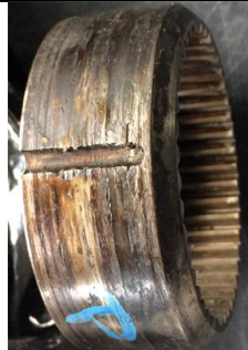
22- Prawidłowe połączenie tulei z wałem korbowym, na rysunku zaznaczono osie kołków unieruchamiających tuleję względem wału korbowego
