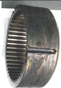
22- Prawidłowe połączenie tulei z wałem korbowym, na rysunku zaznaczono osie kołków unieruchamiających tuleję względem wału korbowego
