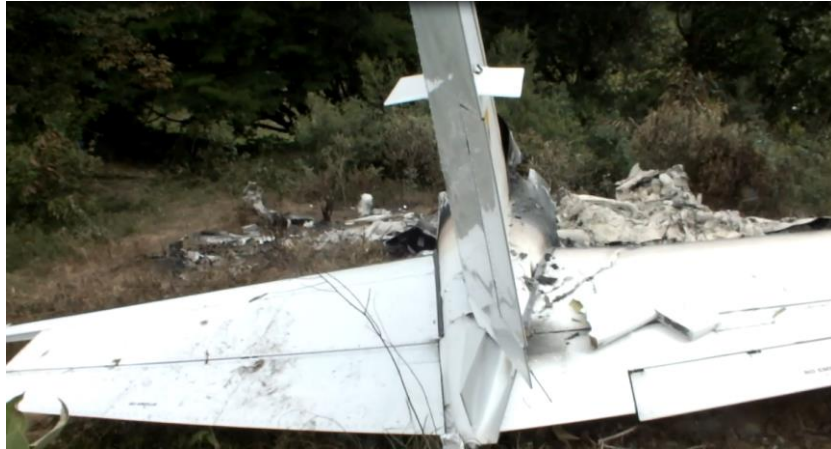
Timón de Dirección: En posición hacia el costado Derecho / Trim en posición Neutral
