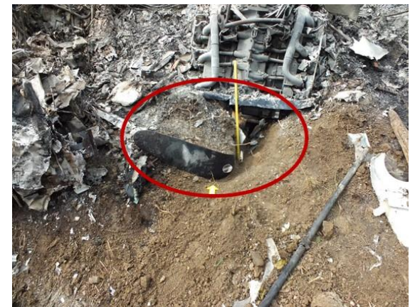
Motor Izquierdo (L) Incrustado en el Terreno / Rulo de la Hélice con Signos de Potencia
