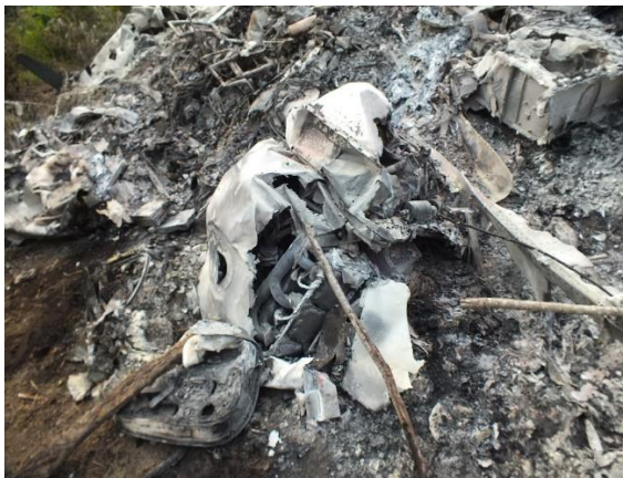
Motor Izquierdo (L) Incrustado en el Terreno / Rulo de la Hélice con Signos de Potencia
