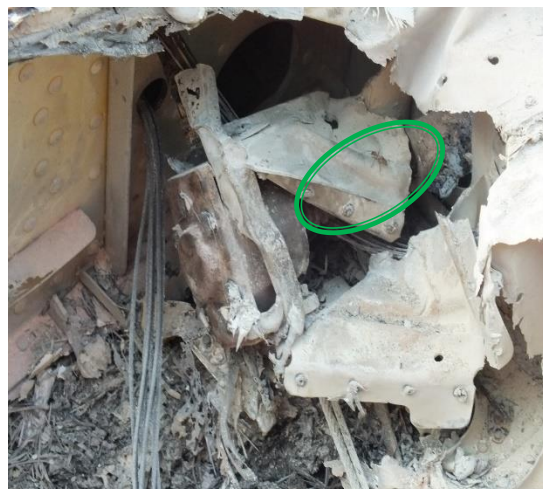
Tornillos Sin Fin: Flap Derecho (R) Color Rojo / Flap Izquierdo (L) Color Verde En Posición Arriba
