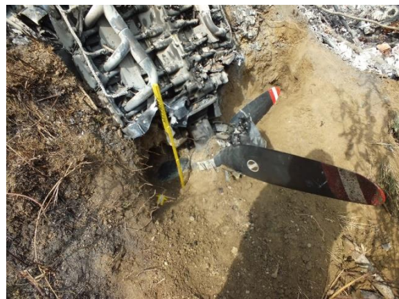
Motor Derecho (R) Incrustado en el Terreno / Palas en Posición Perfiladas
