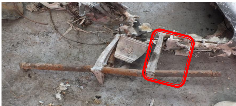
Pedal Derecho en Posición de Máxima Deflexión Adelante
