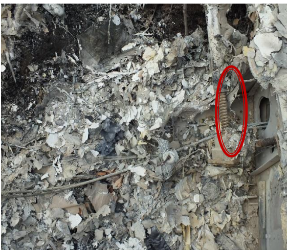
Tornillos Sin Fin: Flap Derecho (R) Color Rojo / Flap Izquierdo (L) Color Verde En Posición Arriba
