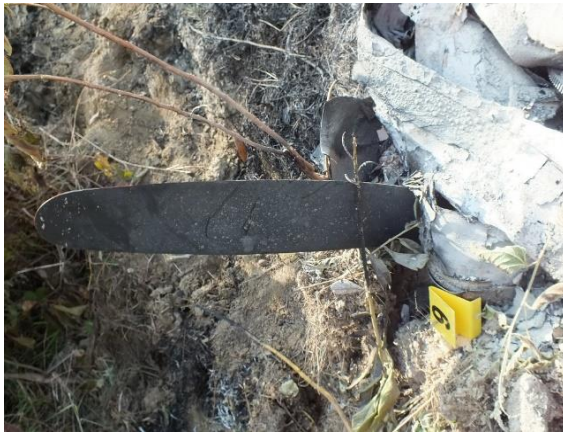
Motor Derecho (R) Incrustado en el Terreno / Palas en Posición Perfiladas
