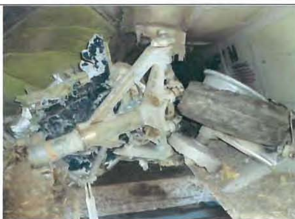
Figura 1.3.3. Pierna de nariz desprendida desde su soporte
