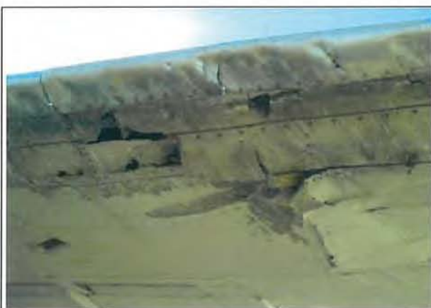
Figura 1.3.2. Punta de la semiala izquierda con daños mayores
