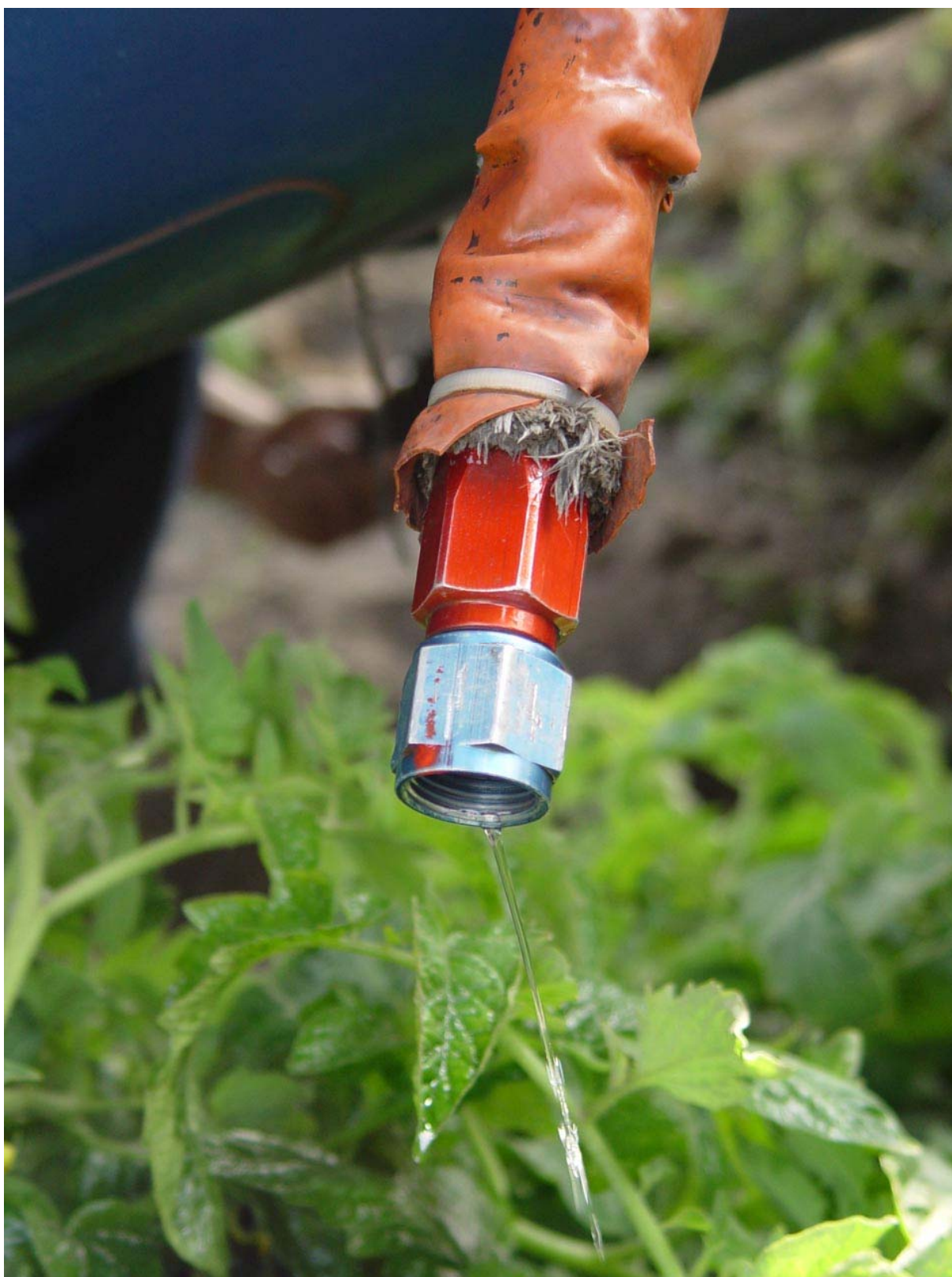
Mínimo flujo de combustible obtenido al poner en funcionamiento la bomba del motor derecho.
