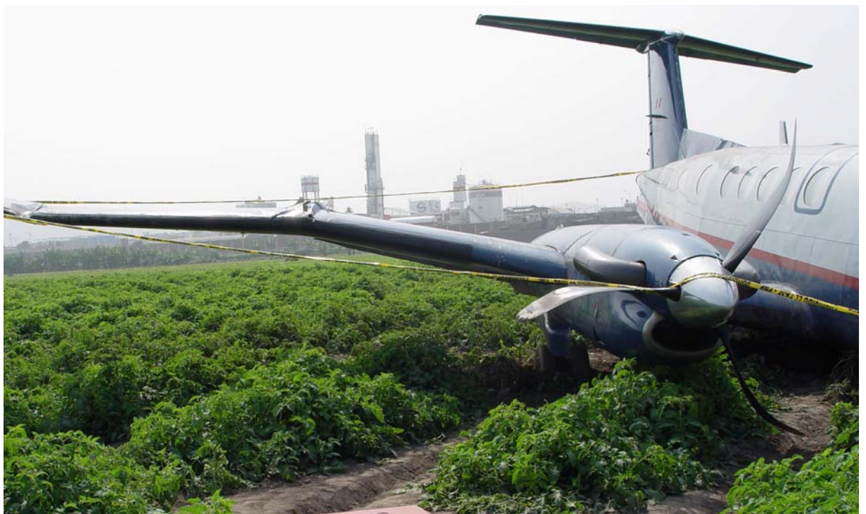
Fotografía de los daños en el ala y palas de hélice del motor derecho.
