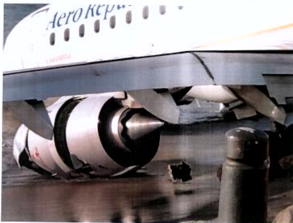
Vista parcial de los daños al motor izquierdo
