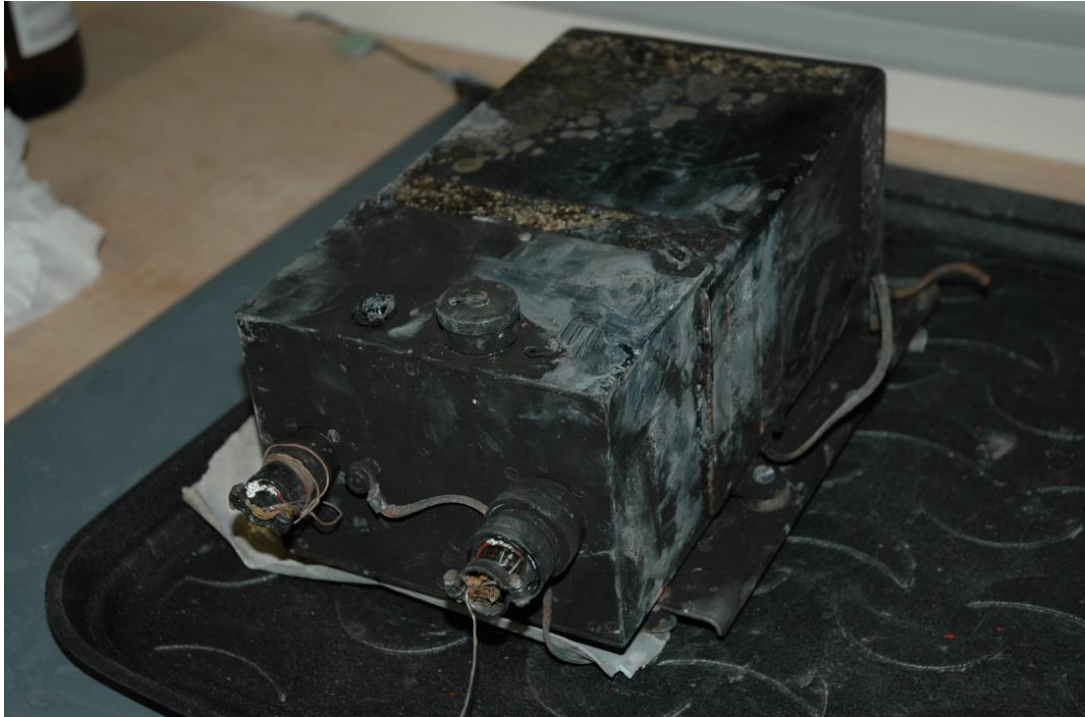
Foto 5: FDR con danni evidenti dovuti all'impatto con il terreno e all'incendio sviluppatosi.
