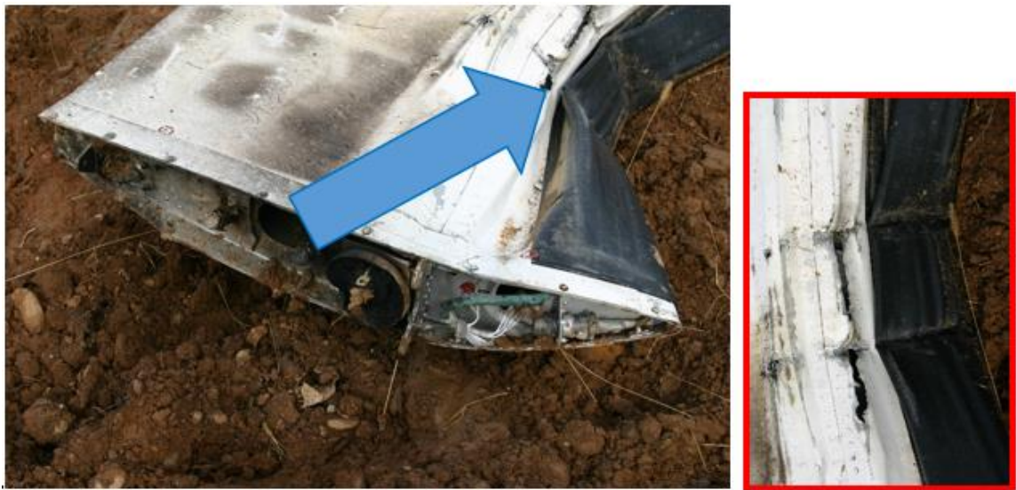
Foto 9: particolari dei danni subiti dalla semiala sinistra all'impatto con i cavi dell'elettrodotto.
