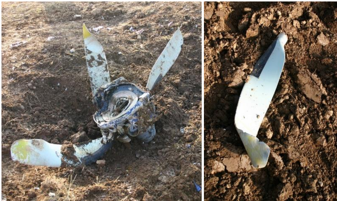
Foto 20 e 21: deformazioni subite dalle pale delle eliche.
