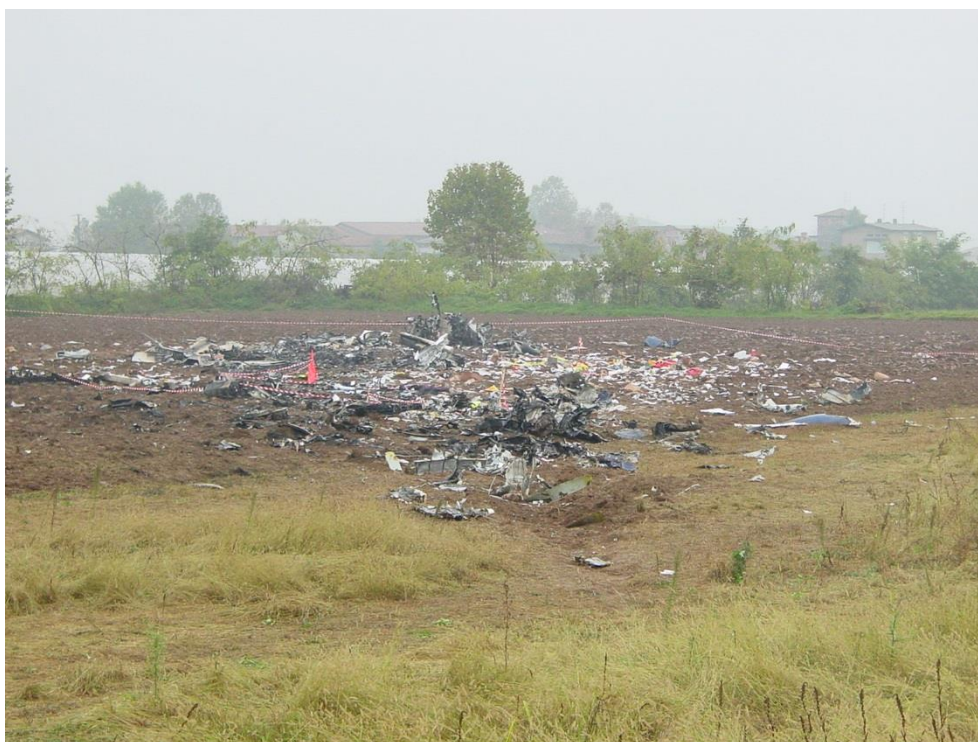
Foto 1: evidenza dell'elevato grado di frammentazione dell'aeromobile.
