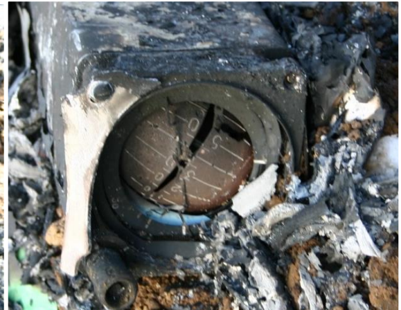
Foto 14 e 15: orizzonte artificiale principale e stand by , rinvenuti tra i rottami.
