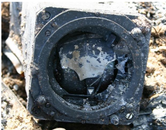
Foto 14 e 15: orizzonte artificiale principale e stand by , rinvenuti tra i rottami.
