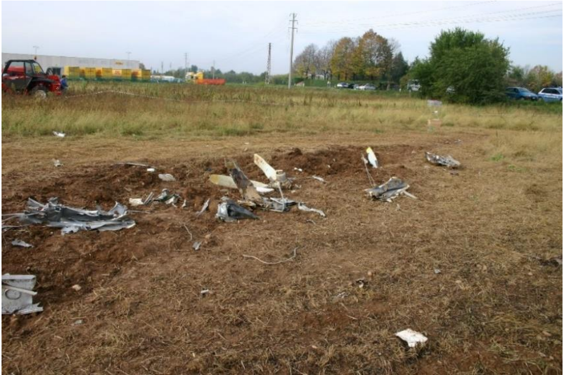
Foto 19: particolare delle pale dell'elica del motore sinistro conficcate nel terreno in prossimità della zona d'impatto.
