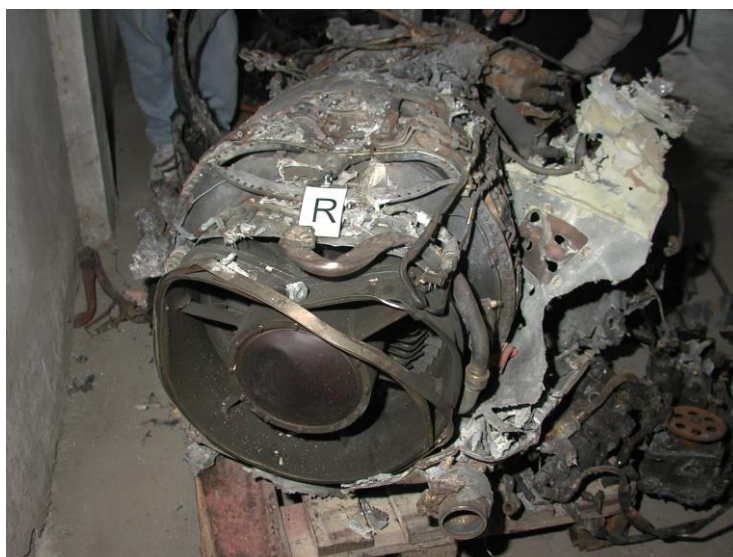
Foto 28: la turbina di bassa pressione del motore destro.
