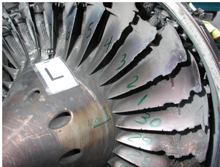
Foto 19: particolare del fan del motore sinistro.
