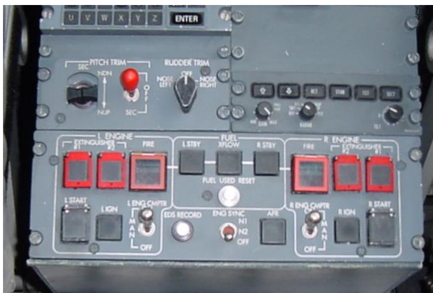
Foto 3: particolare del pedestal con i fire switch ed extinguisher .
