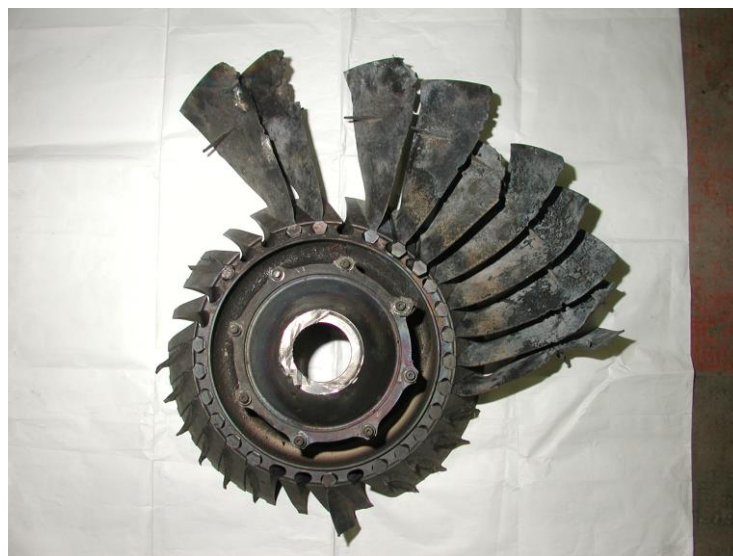
Foto 27: ricostruzione delle palette del fan motore destro.
