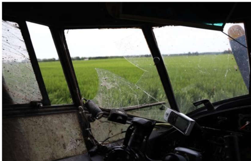
飞机驾驶舱左侧风挡破碎，碎片导致副驾驶头部划伤。
