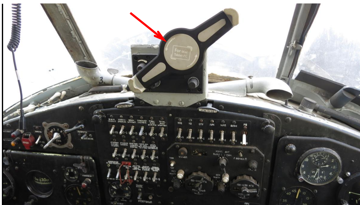
Рис. 3. Место установки планшетного компьютера Explay Onliner 2 в кабине самолета Ан-2 RA-56528 (показано стрелкой)
