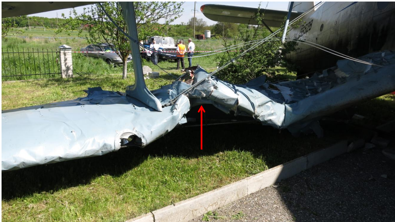
Рис. 7. Место АП. Правая консоль нижнего крыла после АП (зона повреждения от столкновения с кирпичным столбом забора показана стрелкой)
