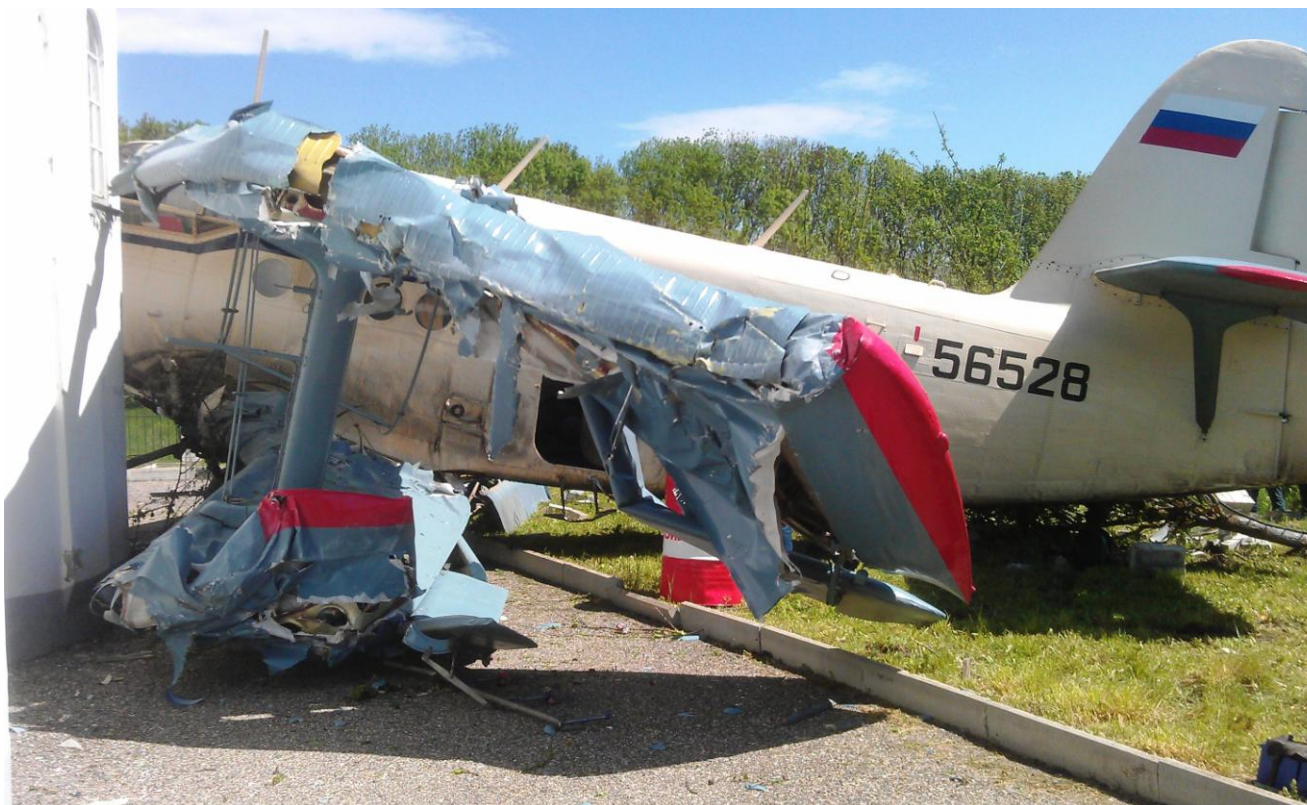
Рис. 8. Место АП. Левые консоли нижнего и верхнего крыльев ВС после АП
