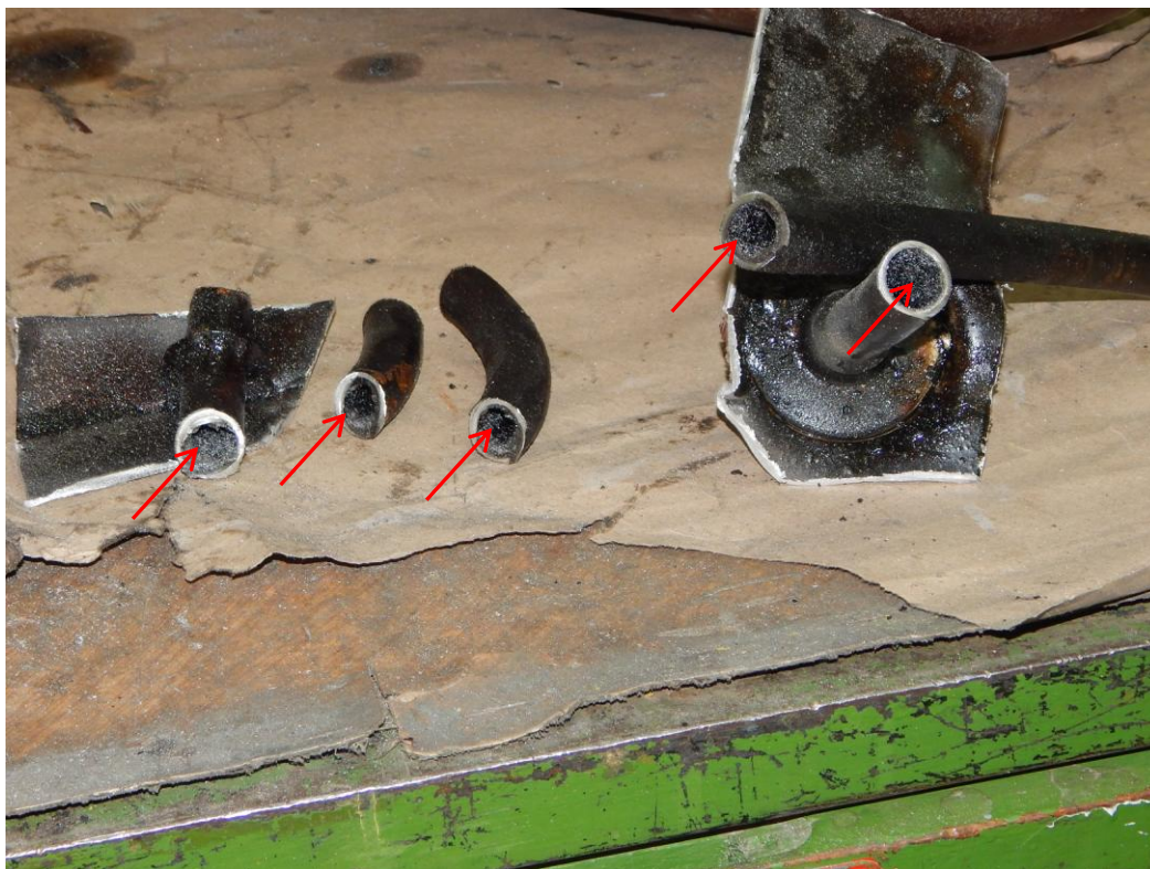
Рис. 18. Отложения нагара и смолы во внутренней полости трубопровода Ш6204-250-4 (показаны стрелками)
