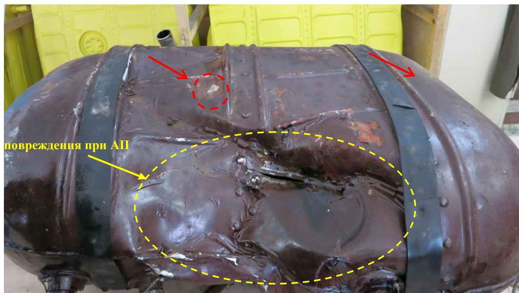
Рис. 14. Повреждение ЛКП и следы наклёпа на маслобаке (показаны красной стрелкой)
