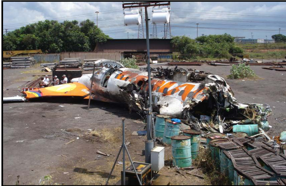
Imagen 2 Restos de la sección posterior del fuselaje de la aeronave después del impacto.
