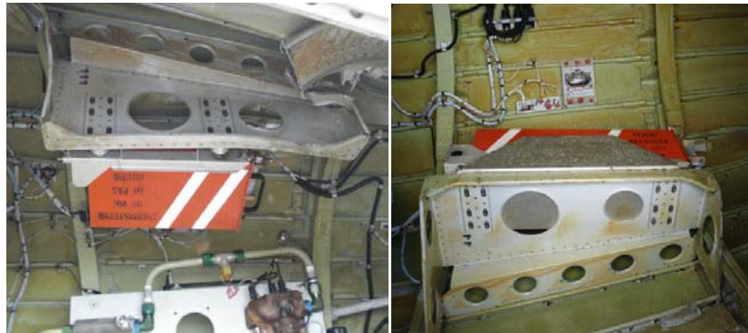
Imagen 7 Condición del DFDR (izquierda) y el CVR (derecha) antes de su remoción.
