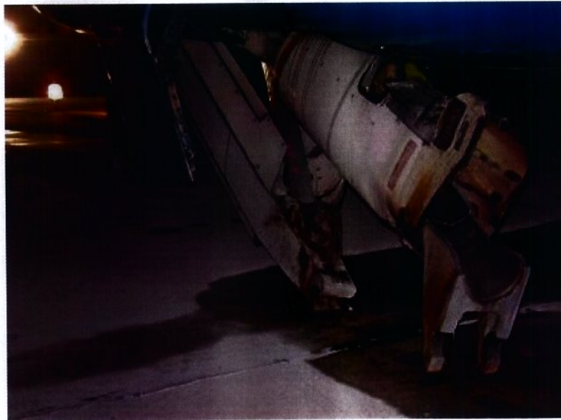
Detalle de los daños en el Tren Principal Derecho
